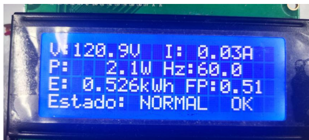
Figura 19 Prueba de fuga a tierra (120.9 V / 0.03 A)
