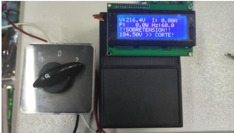
Figura 16 Detección de sobre tensión (216.4 V)
