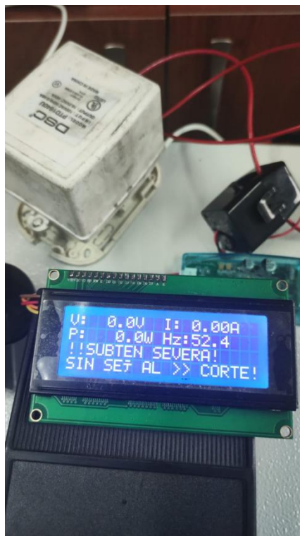
Figura 15 Detección de sub tensión severa (0.0 V)
