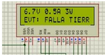
Figura 11 Anomalia de falla a tierra
