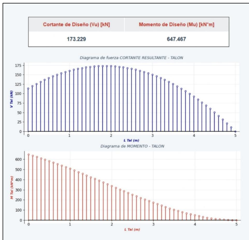
Figura A.20 Cortante y momento de diseño (Talón)
