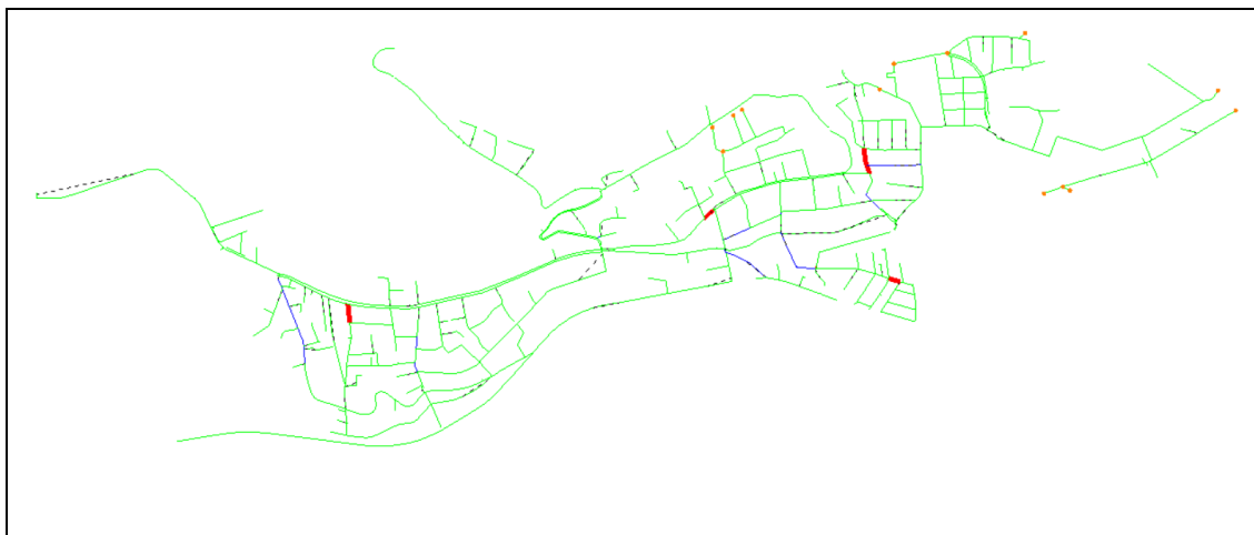
Ilustración 3-9: Red con gradientes críticos tras la instalación de PRVs, Sector 2.1
