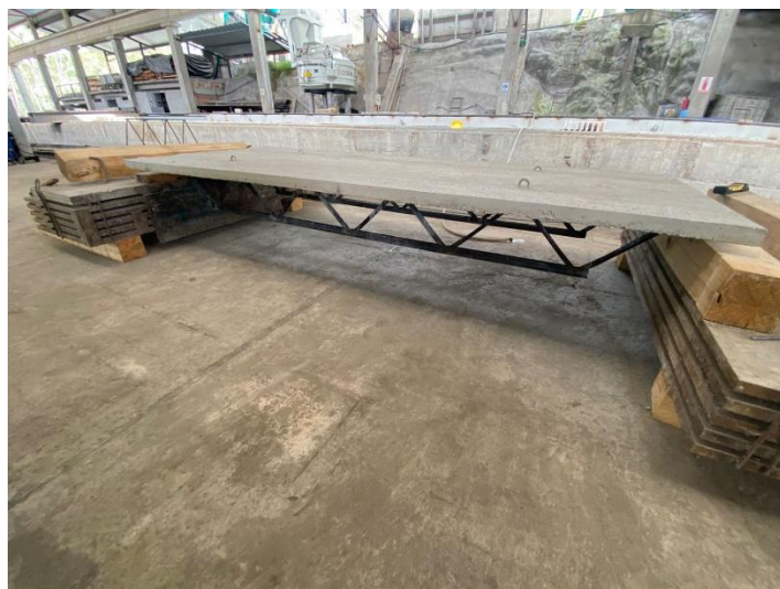
Figura 4-20: Apoyos del modelo construido
