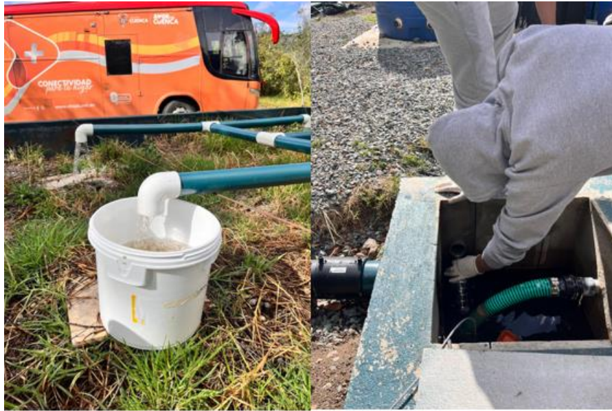
Figura 5. Proceso de la toma de muestra del humedal construido.
