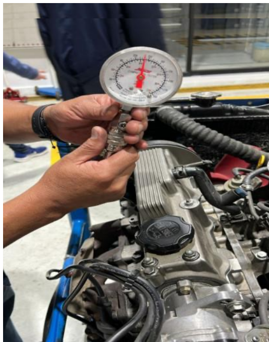
Figura 1 Medición de compresión
