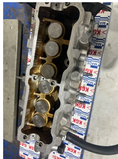
Figura 6 Extracción de muelles, balancines y válvulas del cabezote
