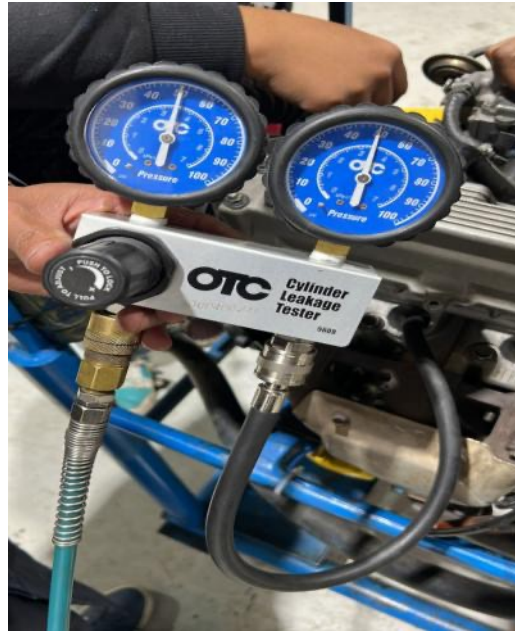
Figura 2 Ensayo de estanqueidad de las cámaras de combustión
