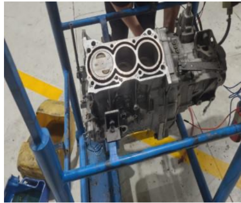
Figura 7 extracción de los pistones
