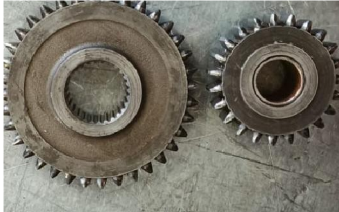
Figura 19 Verificación del estado engranajes
