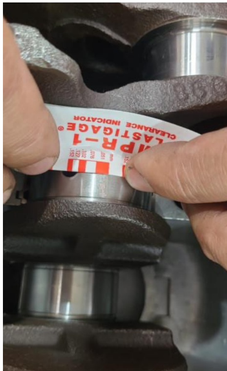
Figura 13 Verificación de ajuste mediante Plastigau
