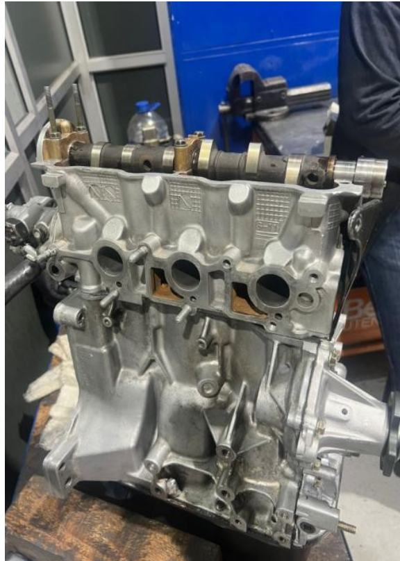
Figura 17 Proceso de montaje de cabezote
