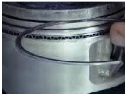
Figura 10 Evaluación de holgura entre anillo y pistón
