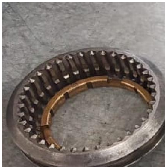
Figura 21 Evaluación del sincronizador del sistema de transmisión
