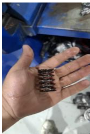
Figura 14 Verificación dimensional de resortes de válvula
