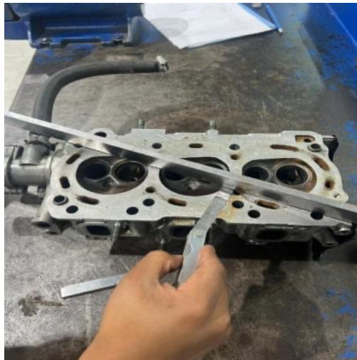
Figura 8 Comprobación de planicidad del bloque y culata
