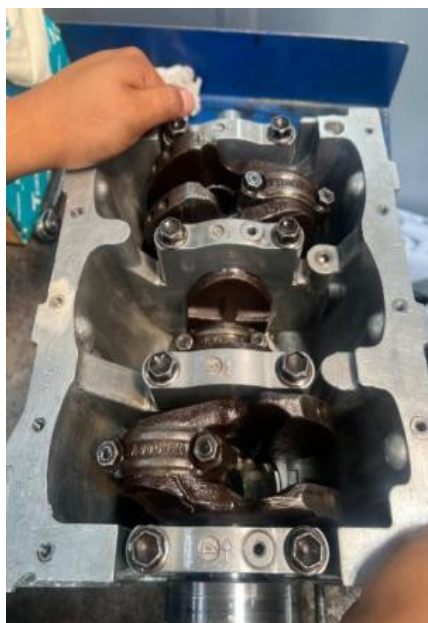
Figura 16 Ensamblaje del bloque de cilindros
