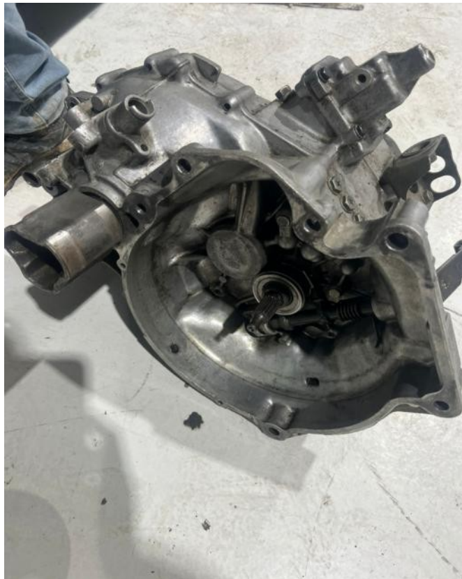
Figura 18 Inspección general de caja de cambios
