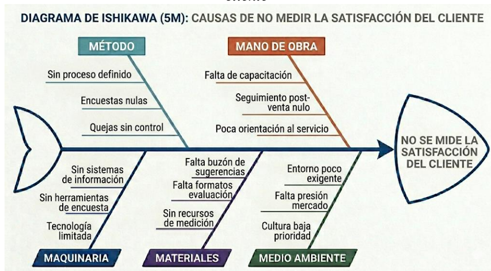
Figura 4 Diagrama de Ishikawa enfocado en la “no medición de la satisfacción de cliente”
