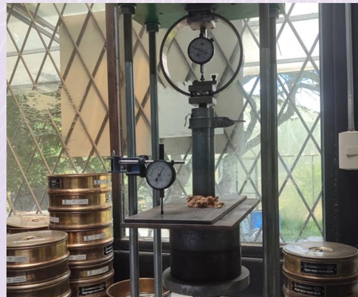
Figura 11. Registro fotográfico del ensayo de compresión en ejecución en probetas de 5x5 cm. Fuente: Rodríguez (2026).
