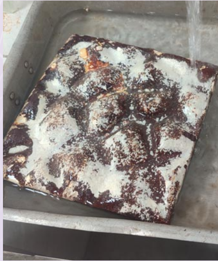
Figura 15. Registro fotográfico de las muestras sumergidas en agua para la determinación del peso húmedo. Fuente: Rodríguez (2026).
