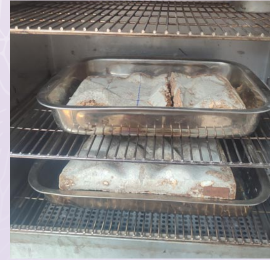
Figura 14. Registro fotográfico del proceso de secado de las muestras en horno eléctrico para la obtención del peso seco inicial. Fuente: Rodríguez (2026).
