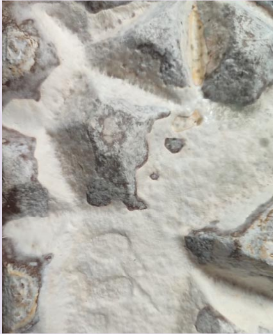
Figura 18. Registro fotográfico del crecimiento del micelio en paneles sin inactivación térmica en ambiente no controlado. Fuente: Rodríguez (2026).
