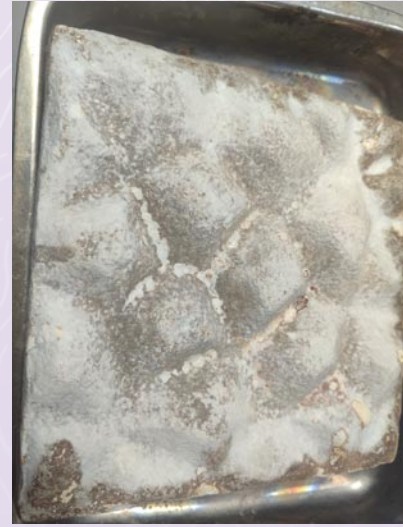
Figura 13. Registro fotográfico del panel con recubrimiento completo de micelio empleado en el ensayo de absorción de humedad. Fuente: Rodríguez (2026).
