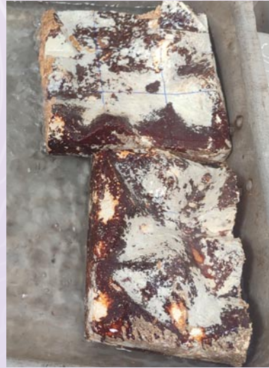
Figura 16. Registro fotográfico del proceso de absorción de agua en las probetas durante el ensayo de humedad. Fuente: Rodríguez (2026).
