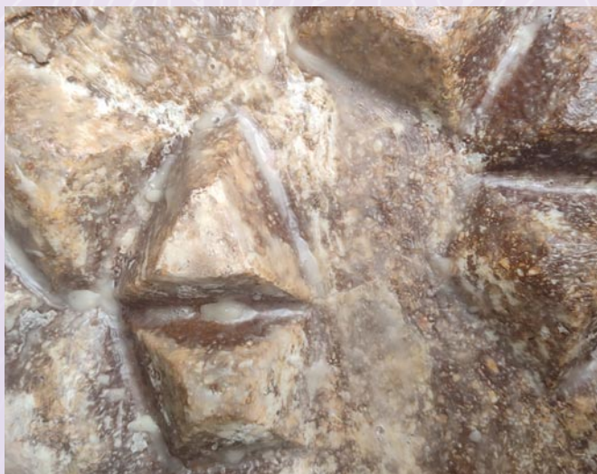
Figura 26. Registro fotográfico del panel de micelio posterior a la aplicación de cera de abeja como sellante natural. Fuente: Rodríguez (2026).
