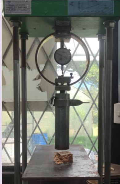
Figura 7. Registro fotográfico del equipo de ensayo de compresión utilizado en probetas de 5×5 cm. Fuente: Rodríguez (2026).
