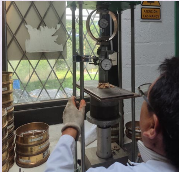
Figura 10. Registro fotográfico de la manipulación de la probeta previo al ensayo de compresión. Fuente: Rodríguez (2026).
