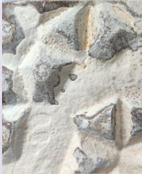
Figura 19. Registro fotográfico del desarrollo progresivo del micelio en condiciones ambientales no controladas. Fuente: Rodríguez (2026).
