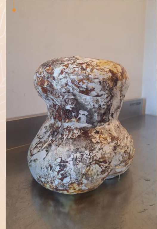
Figura 63. Prototipo desmoldado tras el proceso de crecimiento del micelio, previo a la inactivación térmica. Fuente: Mush Bio Design (2026).
