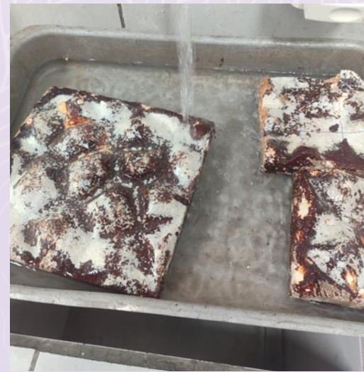
Figura 17. Registro fotográfico de las muestras posterior a la inmersión para el cálculo del nivel de absorción de agua. Fuente: Rodríguez (2026).
