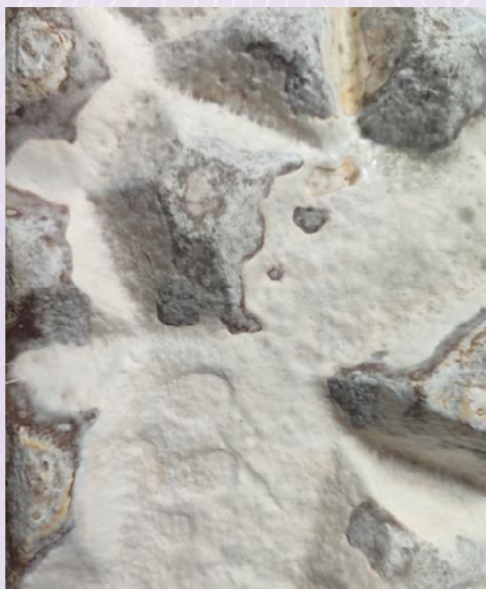
Figura 21. Registro fotográfico de la proliferación del micelio y aparición de agentes contaminantes en el material. Fuente: Rodríguez (2026).
