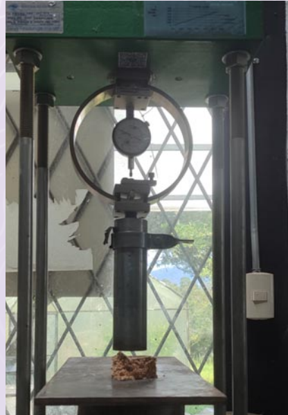
Figura 8. Registro fotográfico de la configuración inicial de la probeta en el equipo de compresión. Fuente: Rodríguez (2026).
