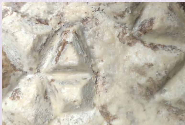
Figura 31. Test de aplicación de cera de abeja para tratamiento superficial
