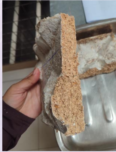
Figura 12. Registro fotográfico del panel con sustrato expuesto utilizado en el ensayo de absorción de humedad. Fuente: Rodríguez (2026).
