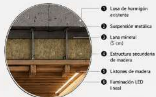
DETALLE 03 CIELO RASO SUSPENDIDO DE MADERA
