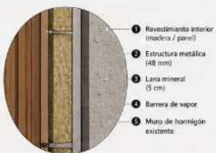
DETALLE 02 MURO CON AISLAMIENTO ACÚSTICO
