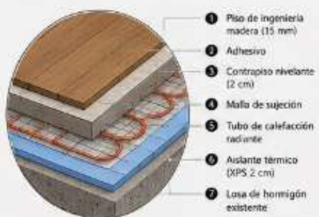
DETALLE 01 PISO CON CALEFACCIÓN RADIANTE
