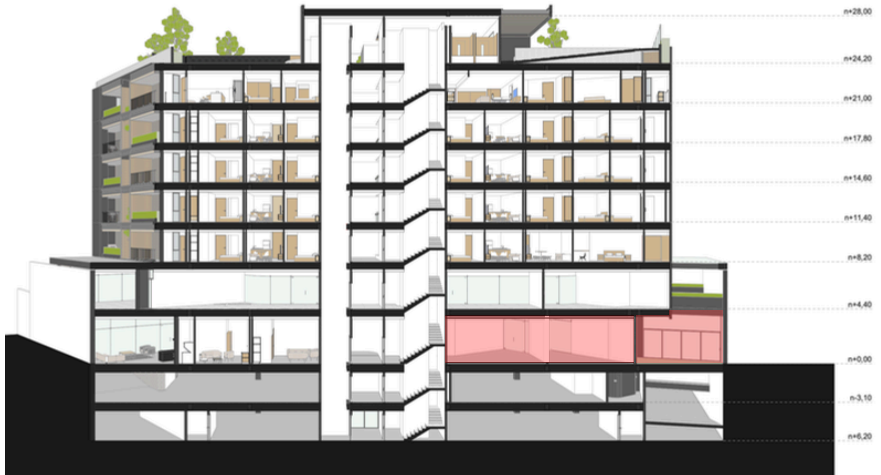
Imagen 37: Corte longitudinal del edificio completo ESC 1:100
