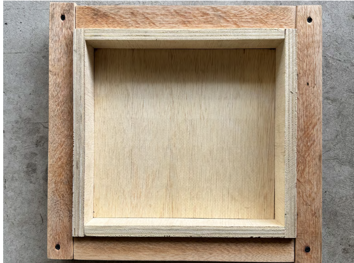
Figura 31 Molde ensamblado y listo para recibir la mezcla de hormigón.
