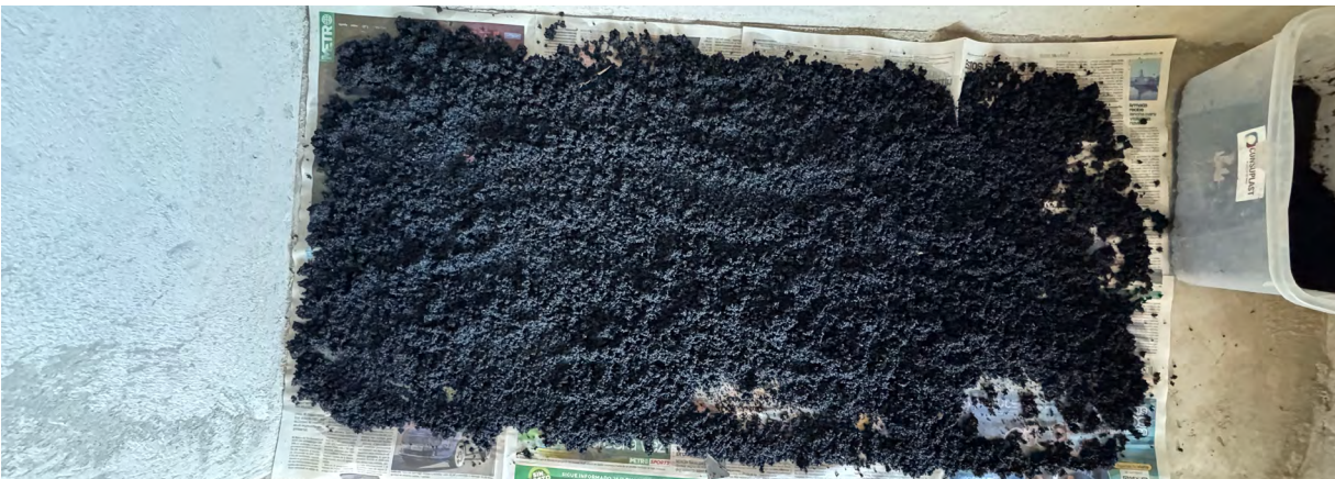
Figura 24 Caucho granulado extendido sobre papel para secado al ambiente durante 24 horas previo a su incorporación a las mezclas.
