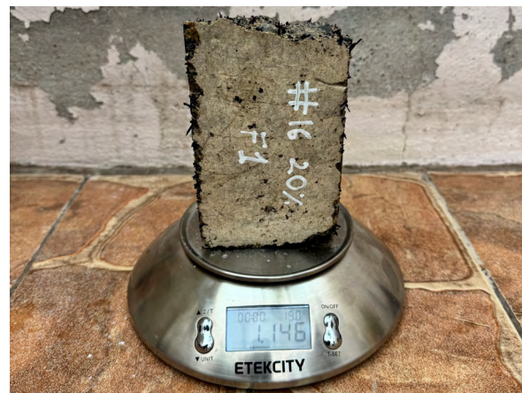
Figura 87 Pesaje de fragmentos tamiz #16 al 20%, en estado saturado previo al cálculo de absorción.
