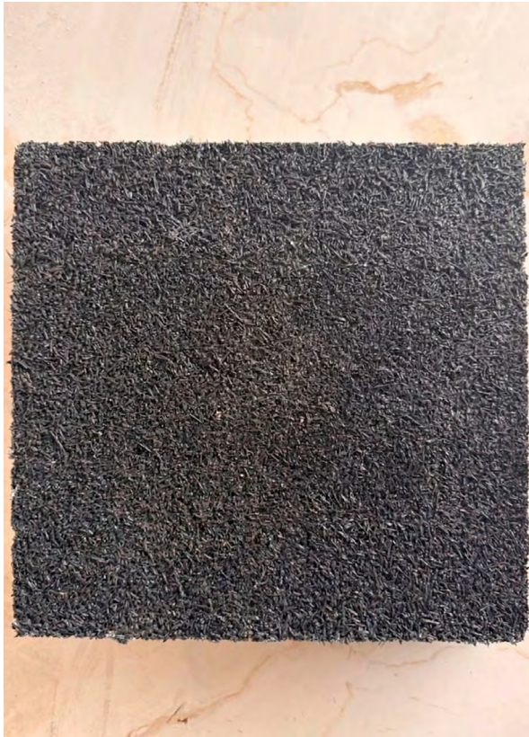
Figura 94 Vista superior de la baldosa BT-0,5 con la capa de caucho compactado.
