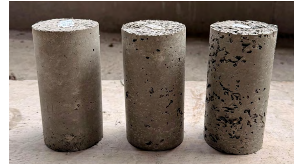
Figura 34 Los tres cilindros piloto desmoldados a las 24 horas de fabricación. De izquierda a derecha: fracción T-8 (2,36–4,75 mm), fracción T-16 (1,18–2,36 mm) y fracción T-30 (0,60–1,18 mm). Se aprecia la diferencia de textura superficial: la fracción T-8 (derecha) presenta mayor porosidad superficial visible, mientras que T-16 y T-30 muestran una matriz más compacta.
