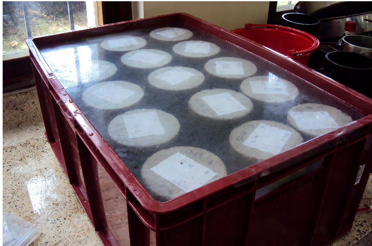
Figura 16 Ejemplo de curado de especímenes de hormigón en condiciones de humedad controlada, posterior al desmoldeo.
