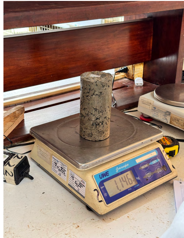
Figura 46 Pesaje de los cilindros en balanza de precisión previo al ensayo de compresión para registro de masa y cálculo de densidad. Se muestra un cilindro a modo representativo.
