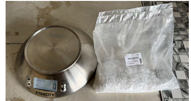
Figura 21 Pesaje de 100 g de hidróxido de sodio en balanza digital.
