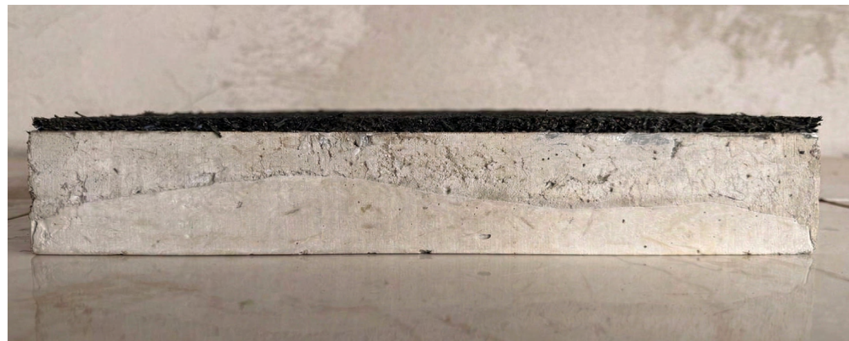
Figura 93 Vista lateral de baldosa BT-05 con capa de caucho superficial, mostrando la unión hormigón-caucho.
