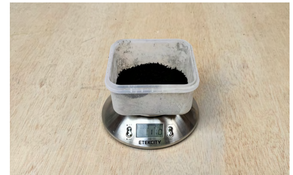
Figura 28 Pesaje de caucho granulado tratado (110 g para la dosificación al 20 %).
