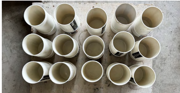
Figura 29 Moldes cilíndricos de PVC ( \varnothing 71 \times 142 mm) para las fundiciones de la fase principal.
