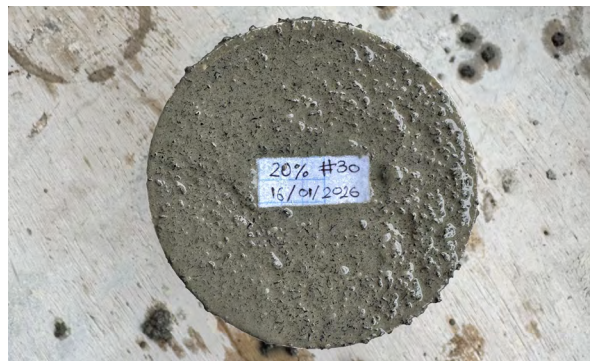
Figura 36 Compactación de la mezcla en el molde cilíndrico con varilla de \varnothing 16 mm.
