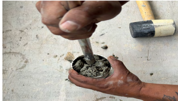
Figura 33 Compactación de la mezcla en el molde cilíndrico con varilla de \varnothing 16 mm.
