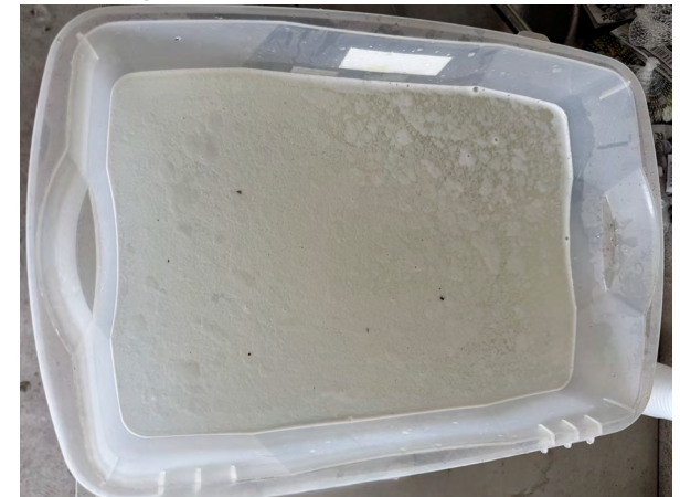
Figura 22 Solución de hidróxido de sodio al 10 % preparada y diluida, lista para el proceso de inmersión.
