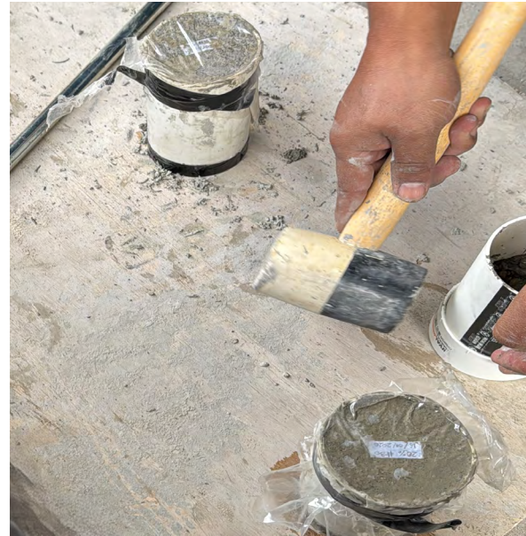
Figura 39 Compactación de los cilindros de la fase principal con mazo de goma y varilla.
