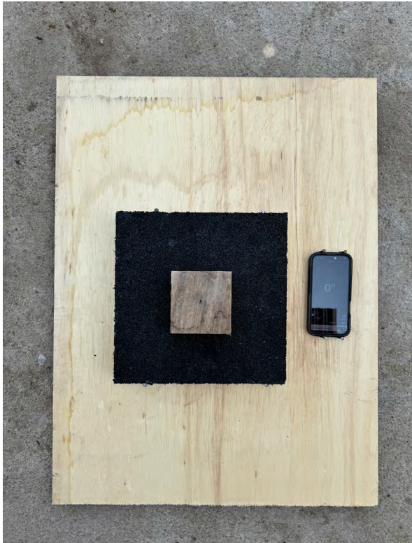
Figura 97 Ensayo de deslizamiento sobre baldosa BT-0,5: bloque sobre la superficie de caucho y registro de 0°.
