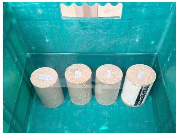
Figura 42 Cilindros sumergidos en tina plástica para curado húmedo. Se observan las etiquetas de identificación en la cara superior de cada espécimen, indicando la dosificación y la fecha de fabricación.
