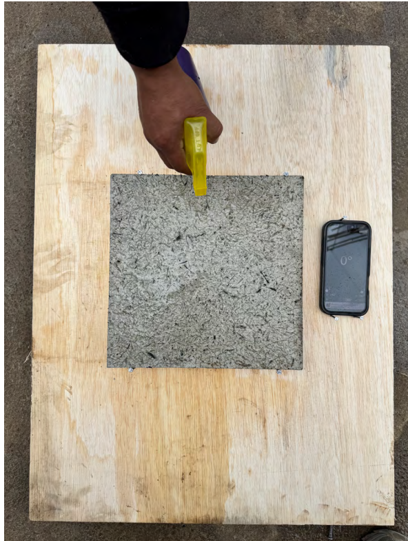
Figura 56 Humedecido previo de la baldosa con rociador de agua y nivel inicial en 0°.
