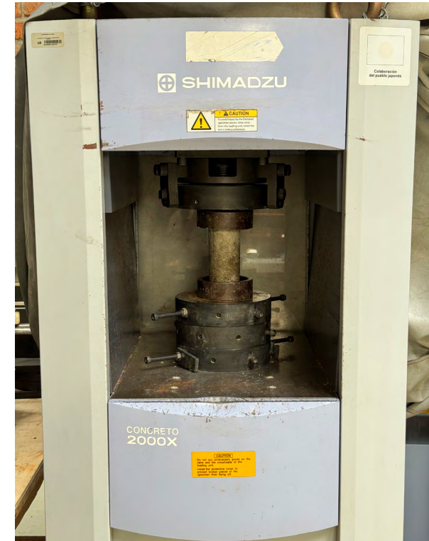
Figura 47 Ensayo de resistencia a la compresión en prensa universal Shimadzu (CON-SETO 2000X). Se observa el cilindro posicionado entre las placas de carga.
