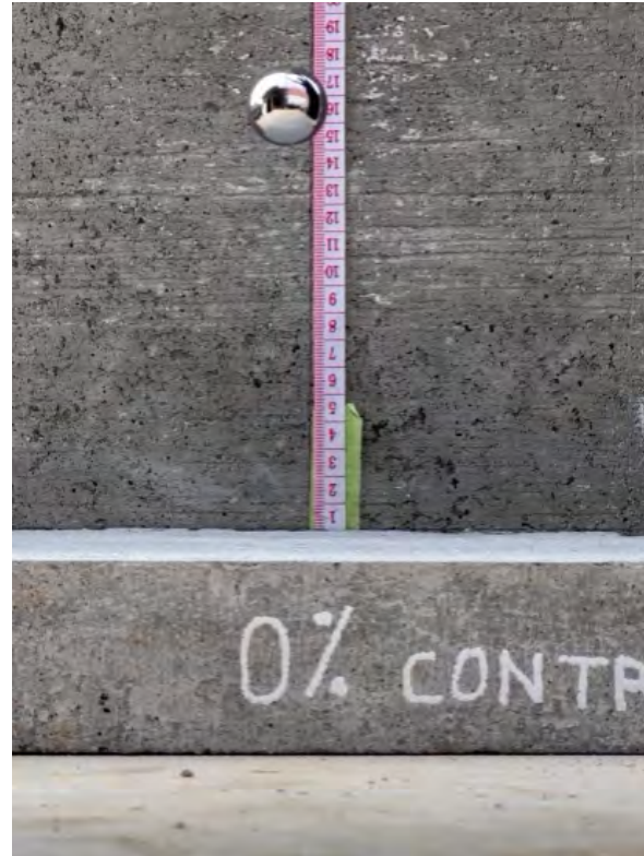
Figura 63 Medición del rebote en baldosas 0%, control con cinta métrica vertical.
