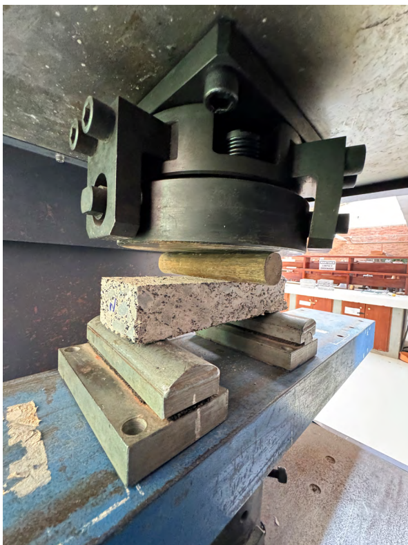
Figura 76 Colocación de la franja en la prensa con los rodillos de apoyo y lámina de compresión.
