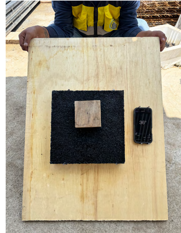
Figura 99 Ensayo de deslizamiento sobre baldosa BT-0,5: bloque sobre la superficie de caucho y registro de 36° en teléfono celular.
