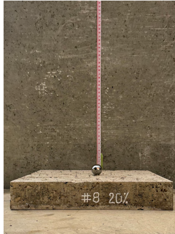
Figura 60 Medición de la altura de rebote con cinta métrica sobre baldosa.
