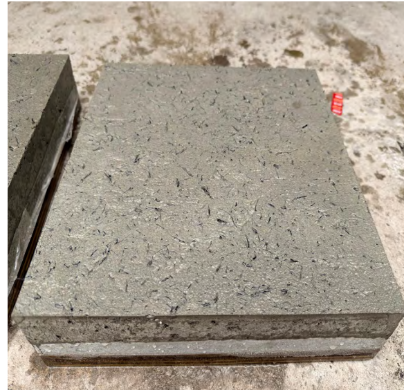
Figura 44 Detalle de la superficie de una baldosa con caucho fracción T-8. Las fibras y partículas de caucho expuestas en la cara superior generan una textura rugosa.
