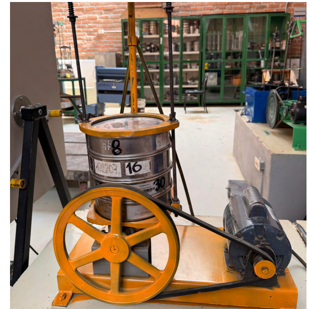
Figura 17 Tamizadora mecánica con tamices #8, #16 y #30 montados. Laboratorio de Mecánica de Suelos, Universidad de Cuenca.
