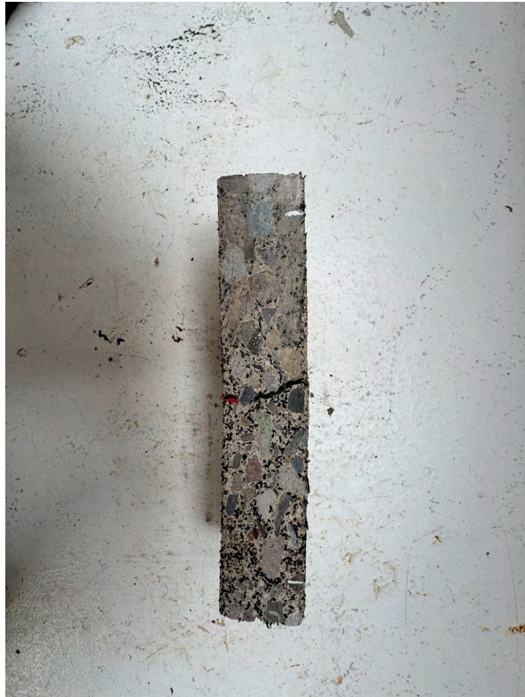
Figura 79 Grieta de rotura, fibras de caucho actúan como refuerzo.
