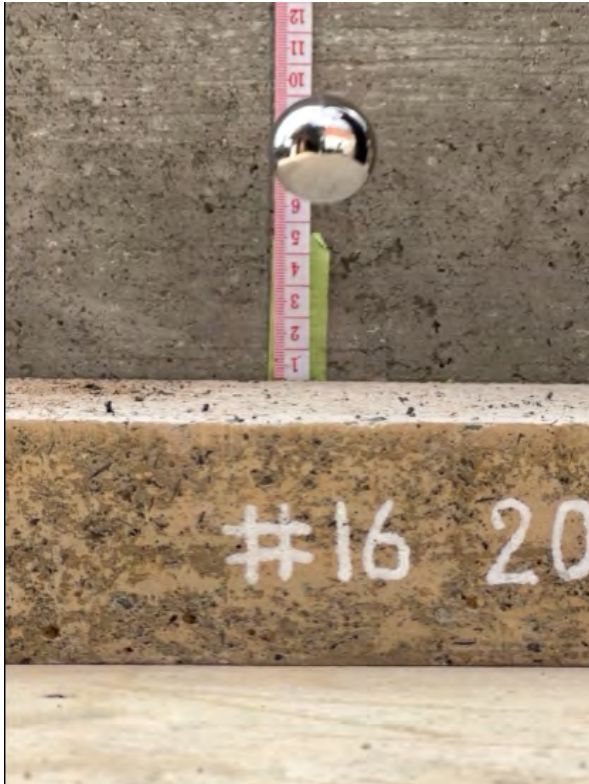
Figura 62 Medición del rebote en baldosas #16-20 %, control con cinta métrica vertical.
