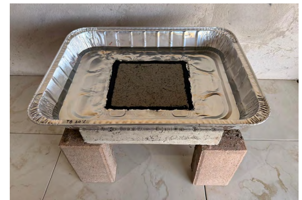
Figura 65 Bandeja de aluminio con recorte de 200×200 mm sellada con silicona.
