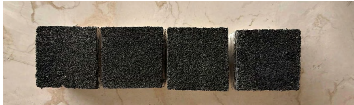
Figura 92 Vista superior de las baldosas con tratamiento superficial de caucho reciclado mostrando la textura homogénea y compacta de la capa de caucho en los cuatro espesores ensayados.
