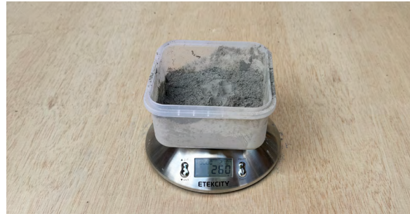
Figura 25 Pesaje de cemento Portland IP (260 g).
