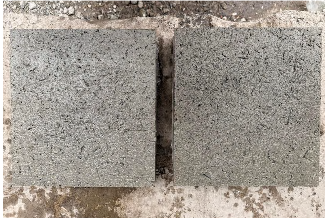
Figura 43 Vista superior de los especímenes de baldosa desmoldados. Se aprecia la textura de la superficie generada por las partículas de caucho expuestas.
