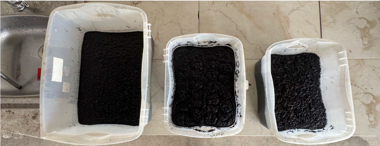
Figura 23 Tres fracciones del caucho granulado sumergidas en solución de hidróxido de sodio al 10 % durante 25 minutos.
