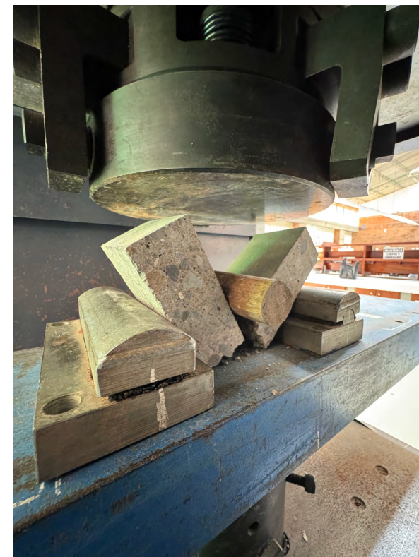
Figura 78 Franja de hormigón de control rotura completa.
