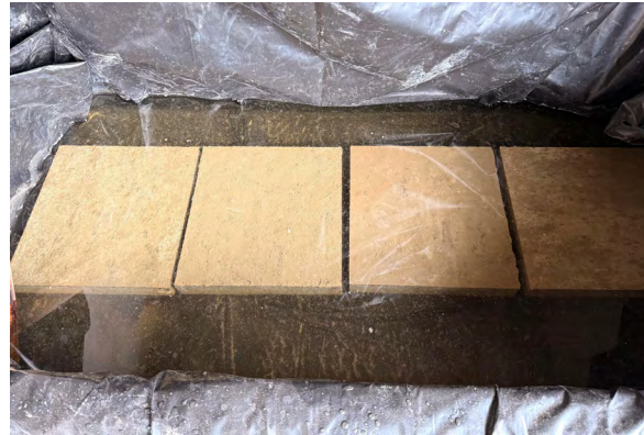
Figura 41 Baldosas sumergidas en agua para curado húmedo hasta los 28 días.
