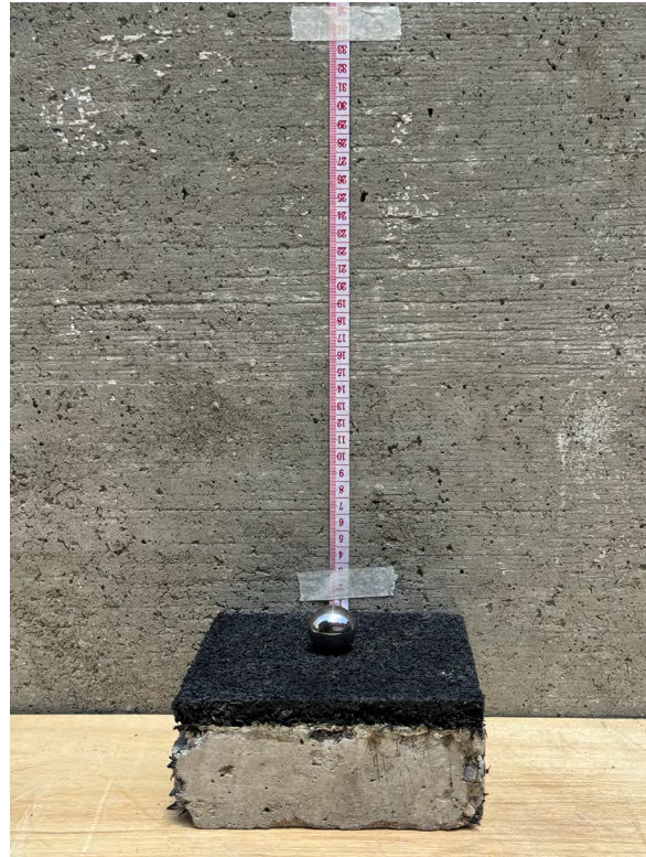
Figura 101 Medición de la altura de rebote con cinta métrica sobre baldosa.
