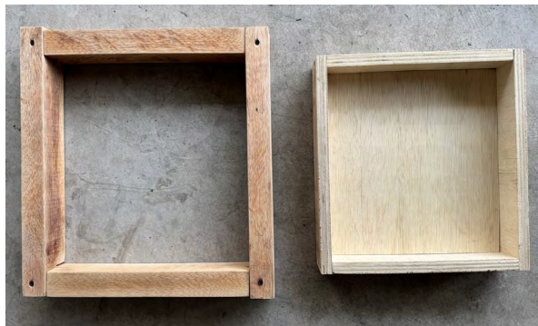
Figura 30 Componentes del molde (base de plywood y marco lateral con tiras de madera).
