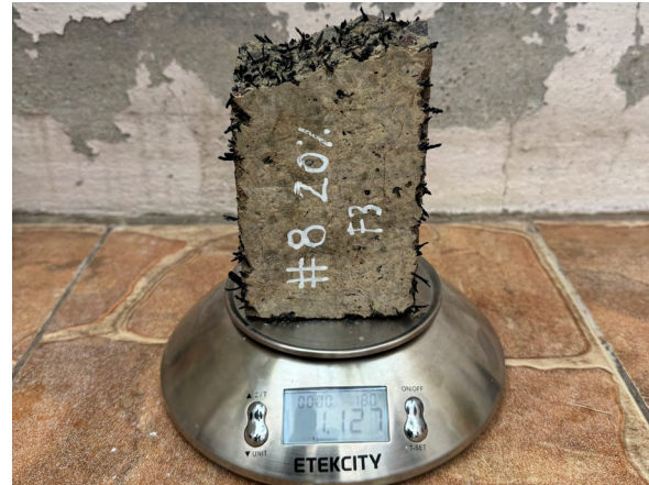
Figura 86 Pesaje de fragmentos tamiz #8 al 20%, en estado saturado previo al cálculo de absorción.
