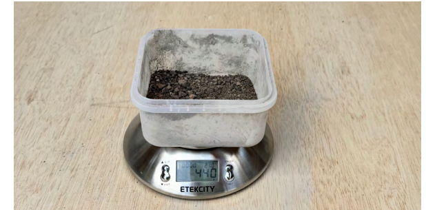
Figura 26 Pesaje de arena (440 g corresponde a la dosificación M-20).
