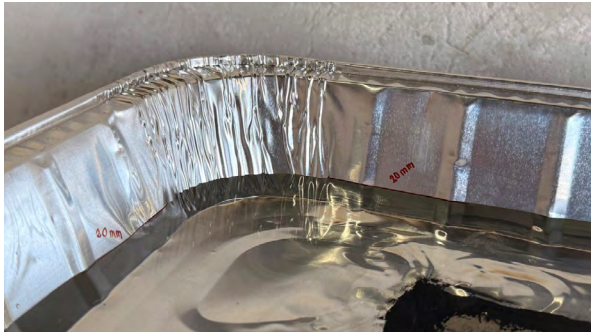
Figura 66 20 mm de agua en contacto directo con la cara superficial de la baldosa. Se deja reposar por 24h
