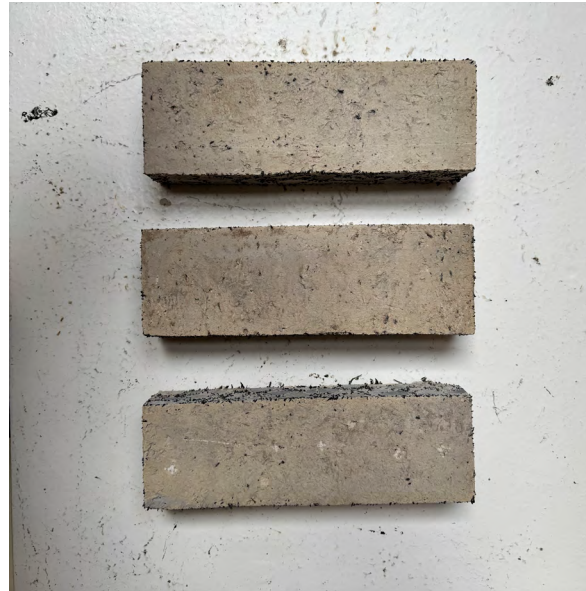
Figura 74 Patrón de corte para ensayo a flexión.
