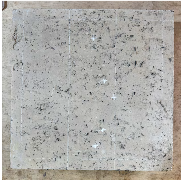
Figura 73 Baldosa marcada según el patrón de corte.
