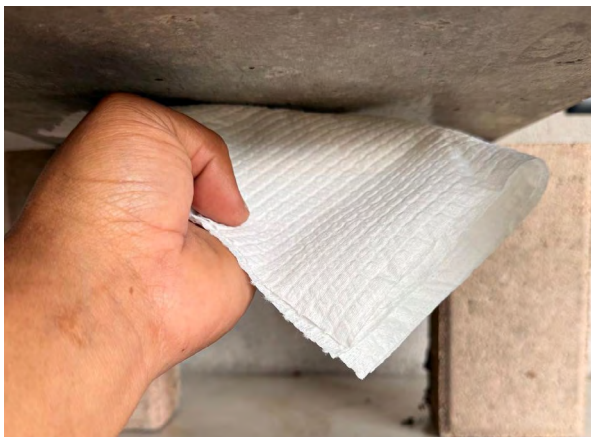
Figura 67 Verificación de la cara inferior con papel absorbente
