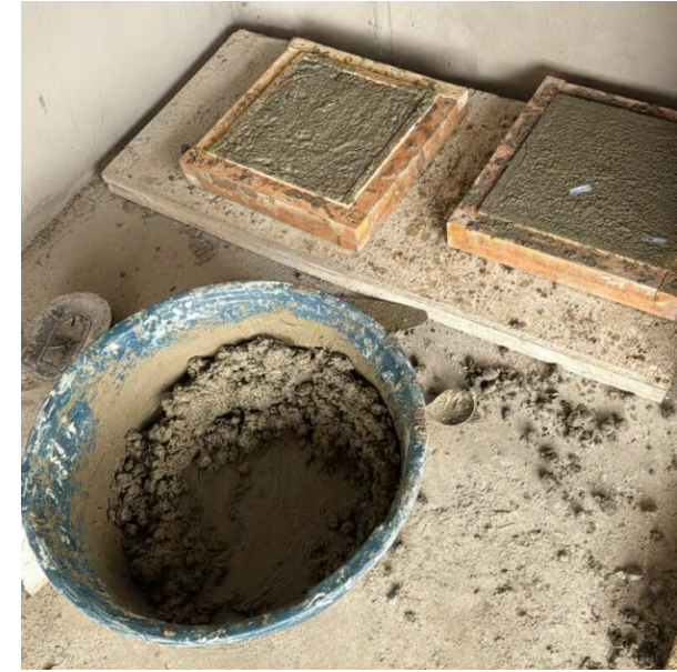
Figura 40 Llenado del molde de madera (cofre) con la mezcla fresca de hormigón con caucho.
