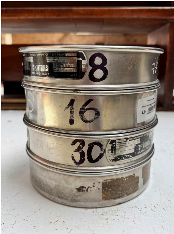
Figura 18 Tamices #8, #16 y #30 apilados.
