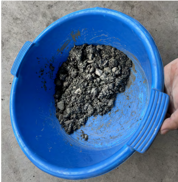
Figura 38 Mezclado manual de una dosificación de la fase principal en recipiente plástico de 15 litros. Se observa la distribución del ripio, cemento y arena antes de la adición del agua.
