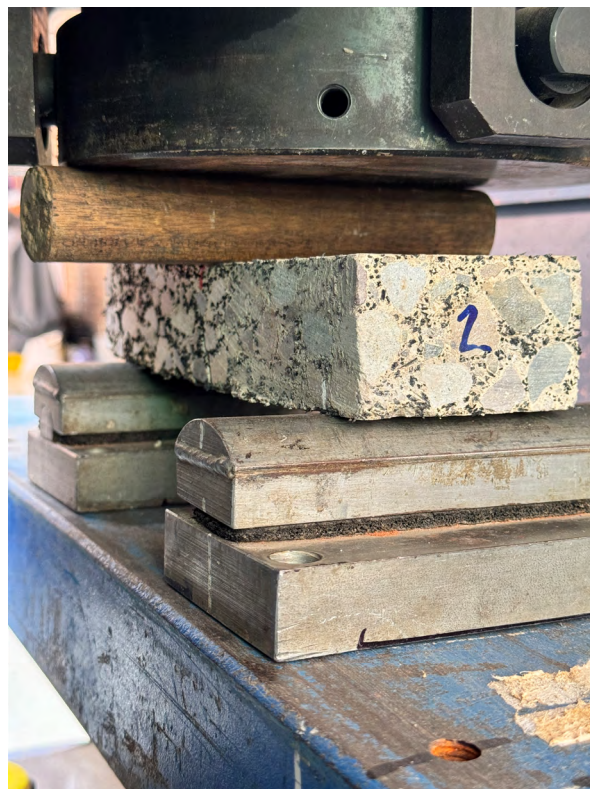
Figura 77 Franja post-rotura mostrando la grieta en el tercio central.
