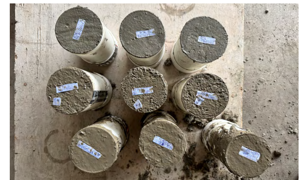
Figura 37 9 de los 15 cilindros de la fase principal recién fabricados, etiquetados y dispuestos para el curado inicial.
