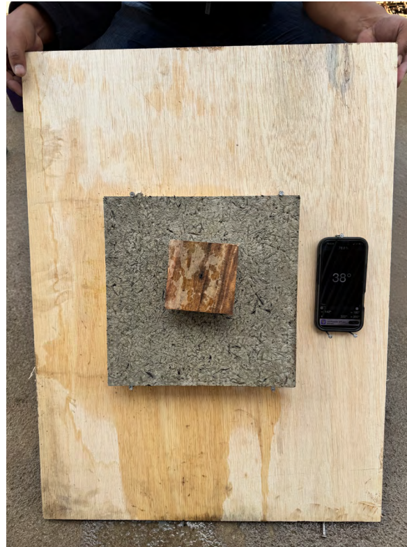
Figura 57 Registro del ángulo de deslizamiento durante el ensayo (38° visible en pantalla).
