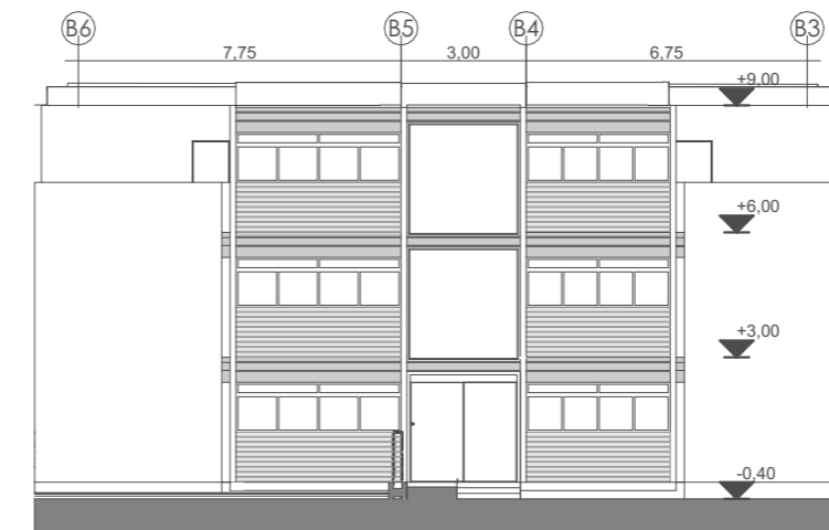
Figura 138. Alzado frontal del bloque B (BF) Elaboración propia (2026). Escala 1:200
