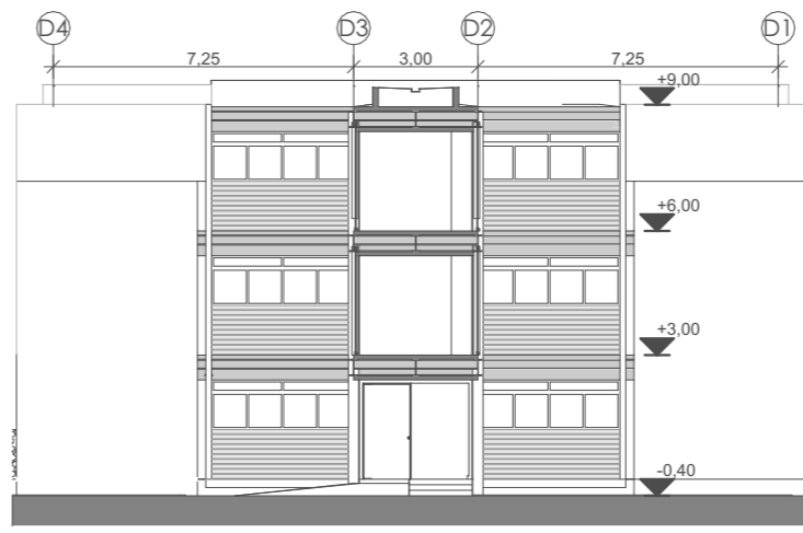
Figura 144. Alzado frontal del bloque D (DF) Elaboración propia (2026).
