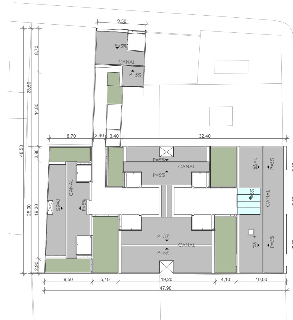
Figura 117. Planta de Cubierta General Elaboración propia (2026). Escala 1:450
