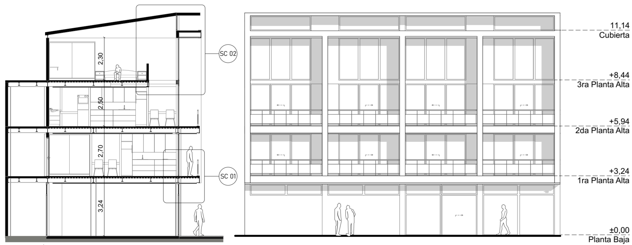
SECCIÓN CONFRONTADA CON FACHADA Esc: 1:125
