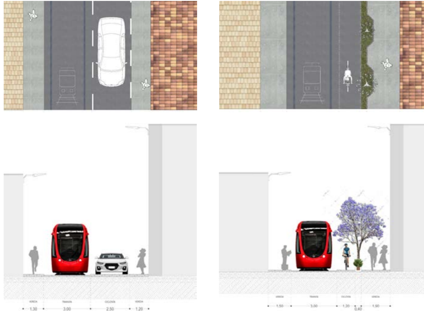
Figura 36. Diagrama comparativo de planta con sección vial. Nota. Se muestra la ingerencia con el tranvía y la comunicación peatonal. Elaboración propia.
