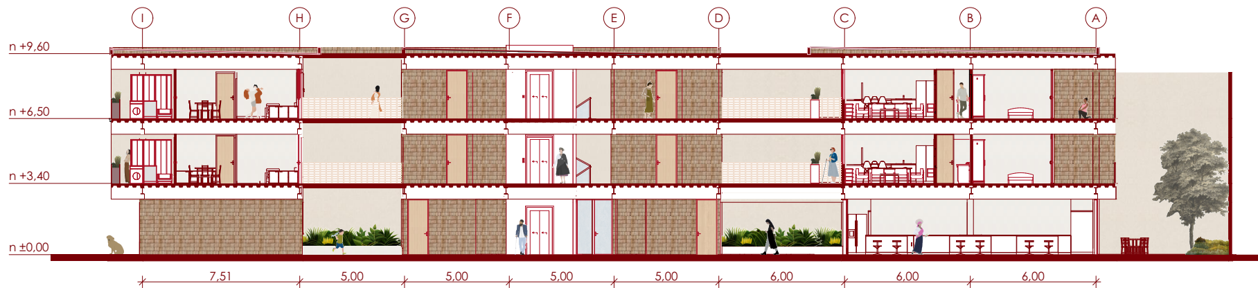
Figura 51. Sección longitudinal A-A. Nota. Elaboración propia
