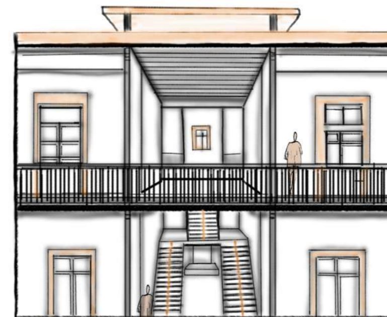
Fig. 23. Restauración de escaleras de estructura liviana de acero y prolongación de alero existente. Redibujo con autoría propia a partir de Bienal Nacional de Arquitectura Mexicana (BNAMX).
