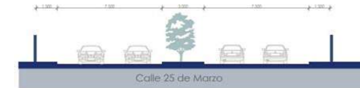
Figura 32. Sección Vial 2- Calle 25 de Marzo. Elaboración propia
