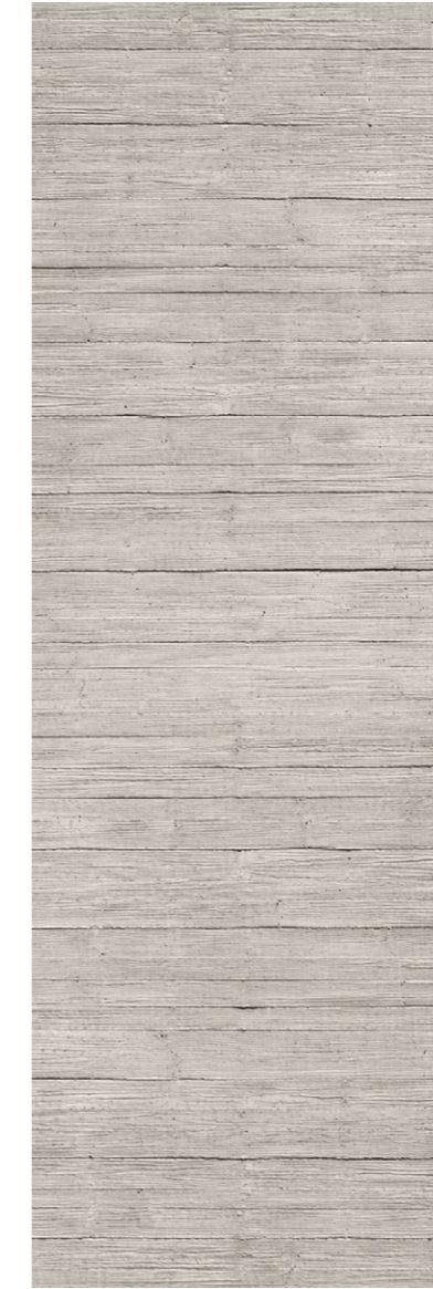
Hormigón texturizado por encofrado
