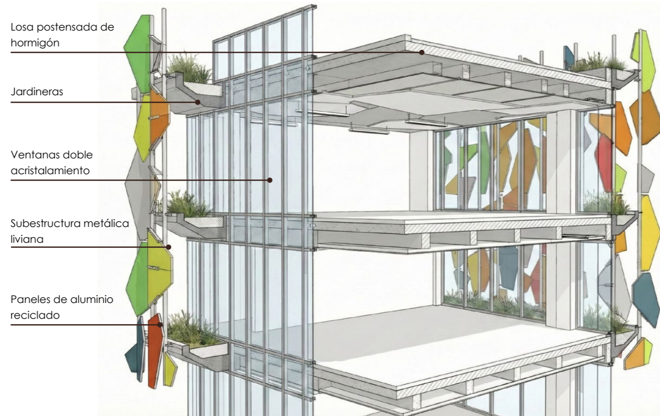
Figura 28 Esquema de resolución constructiva
