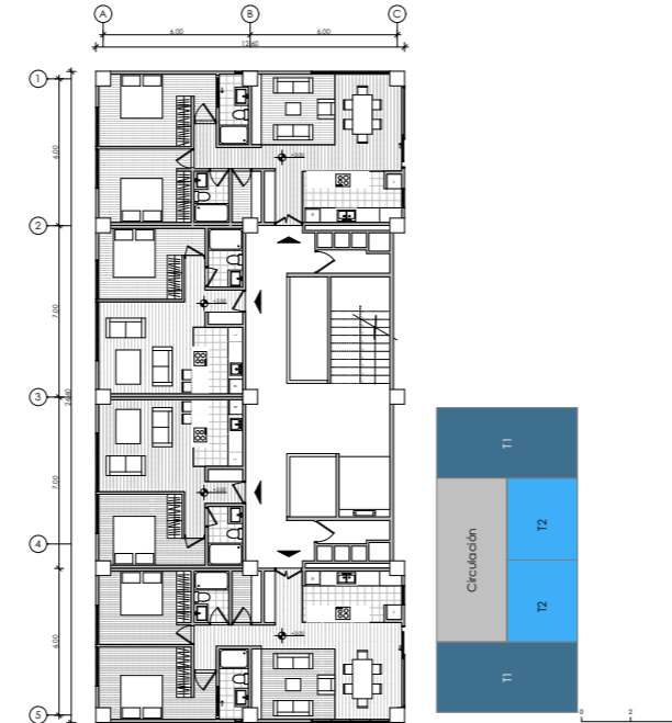
Figura 114: Planta alta (T1). Fuente: Elaboración propia (2026)
