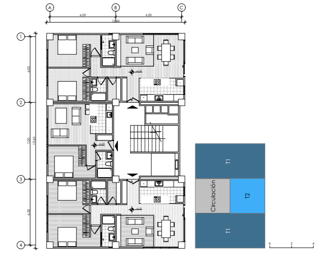
Figura 117: Planta alta (T2). Fuente: Elaboración propia (2026)
