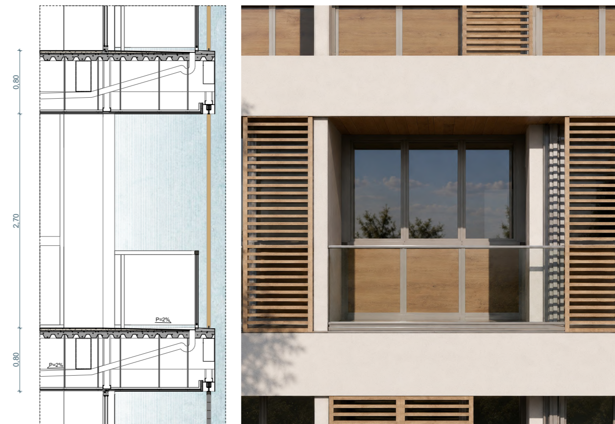
Fuente: Autoría Propia (2026) Figura 147: Sección - fachada.
