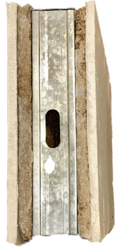
Figura 63: Panel con gypsum y 2 cm de panel de viruta
