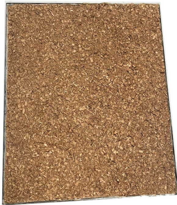
Figura 58: Panel posterior al proceso de cocción
