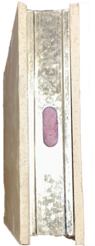
Figura 61: Panel con gypsum y lana de vidrio
