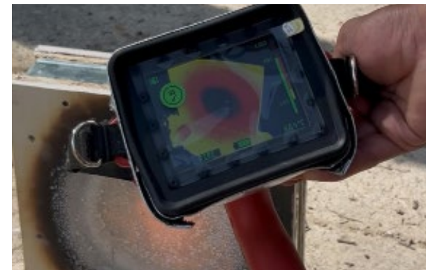
Figura 72: Temperatura final del panel
