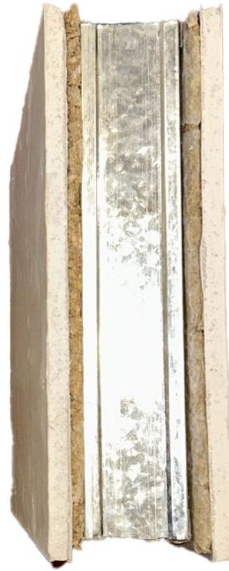
Figura 62: Panel con gypsum y 1 cm de panel de viruta
