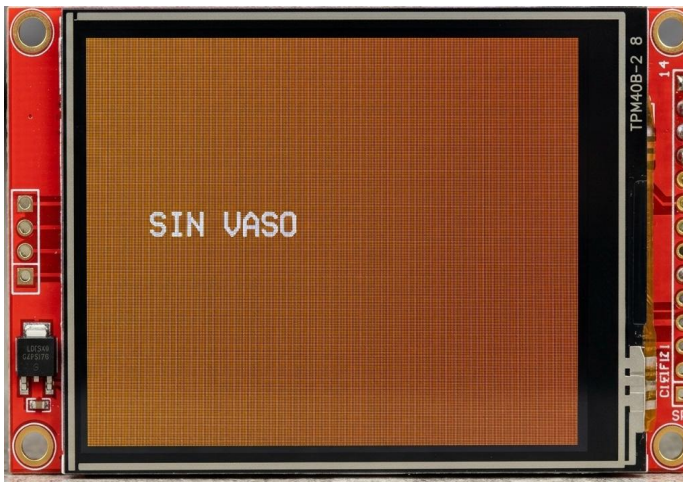
Fig. 14. Pantalla de aviso para prevención de derrames
