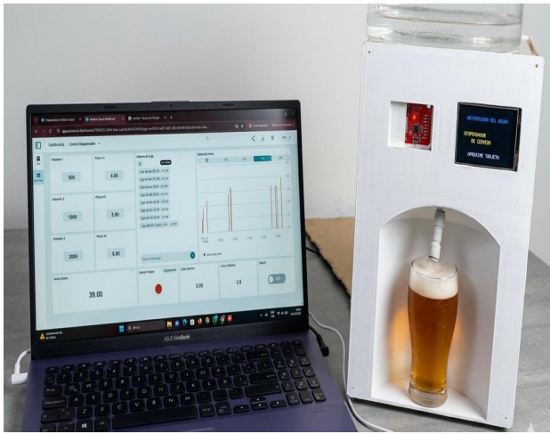
Fig. 17. Ensamble final del dispensador de cerveza
