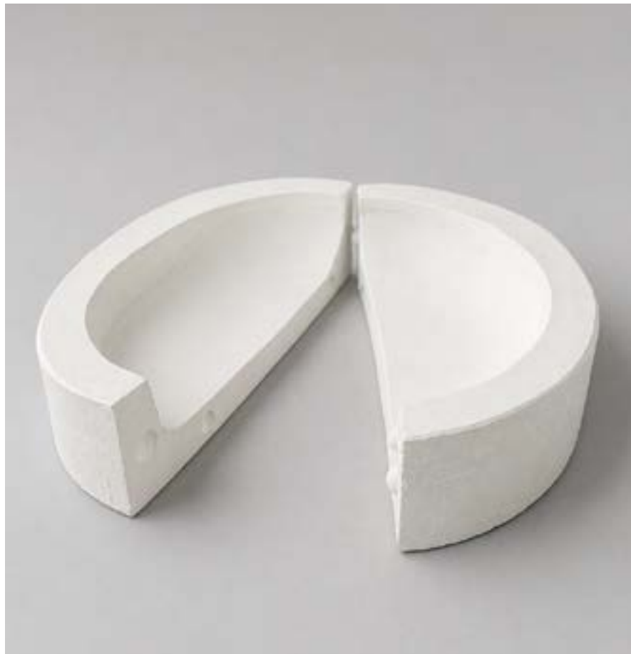
Figura 29. Molde de yeso del plato fuerte abierto.
