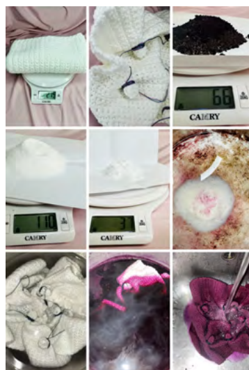
Figura 102. Proceso de teñido shibori en muestra 001.
