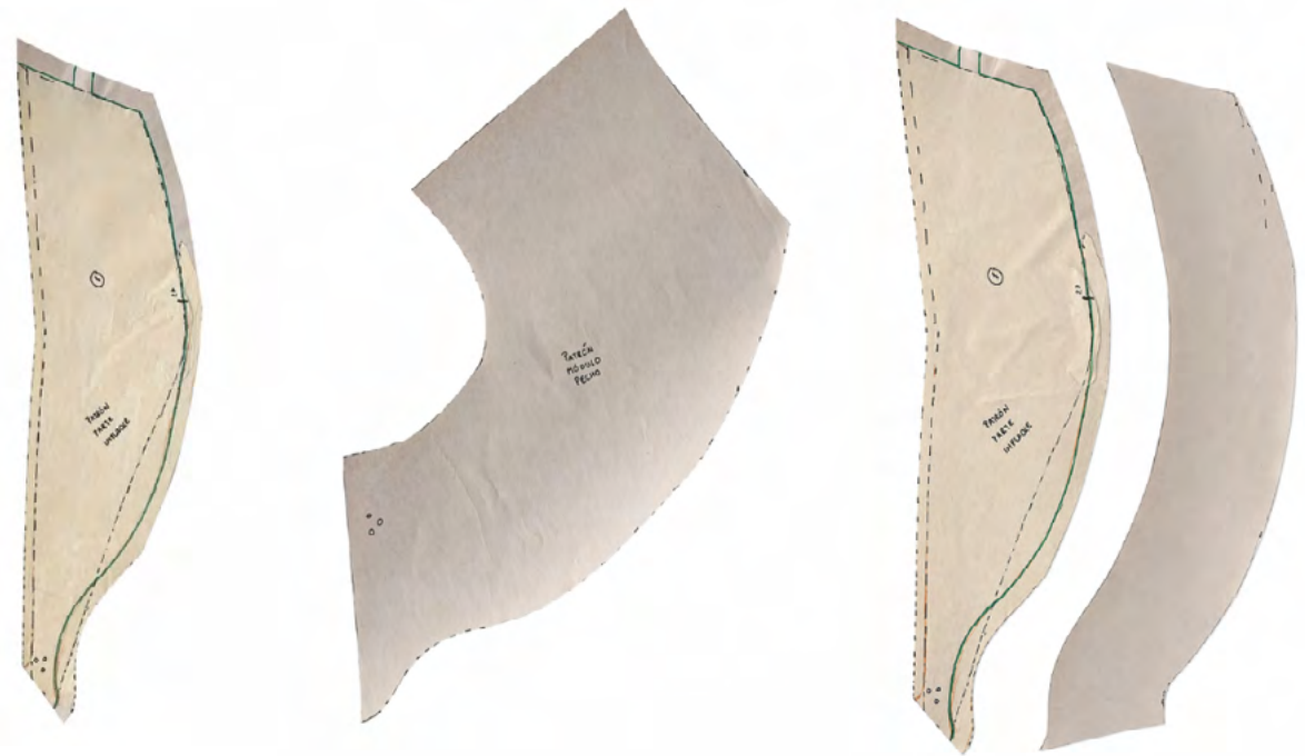
Figura 31. Extracción de los patrones modelados sobre maniquí con correcciones, Nota. Se aumento una pestaña lateral para facilitar la expansión de la cámara de aire sin deformar el resto de la pieza
