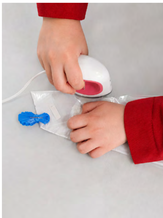
Figura 29. Proceso de termofusión del primer módulo
