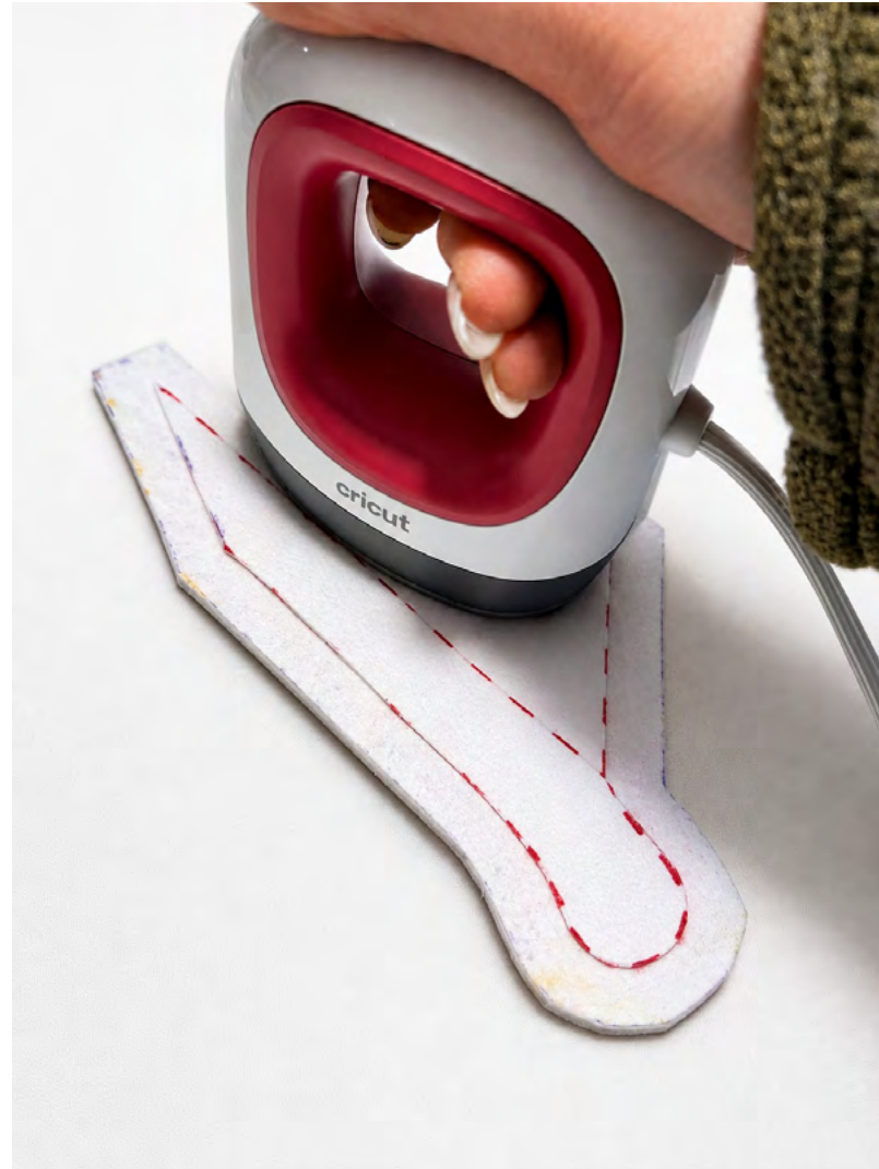
Figura 52. Proceso de termofusión o sellado del módulo de la espalda
