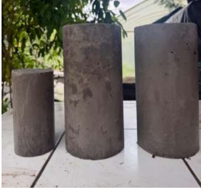
Figura 73. Cilindros de la Mezcla 3 previo al ensayo de compresión, tracción y durabilidad, tras ser extraído del tanque de curado por inmersión de agua.
