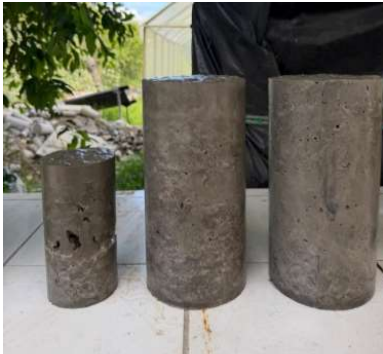
Figura 76. Cilindros de la Mezcla 6 previo al ensayo de compresión, tracción y durabilidad, tras ser extraído del tanque de curado por inmersión de agua.
