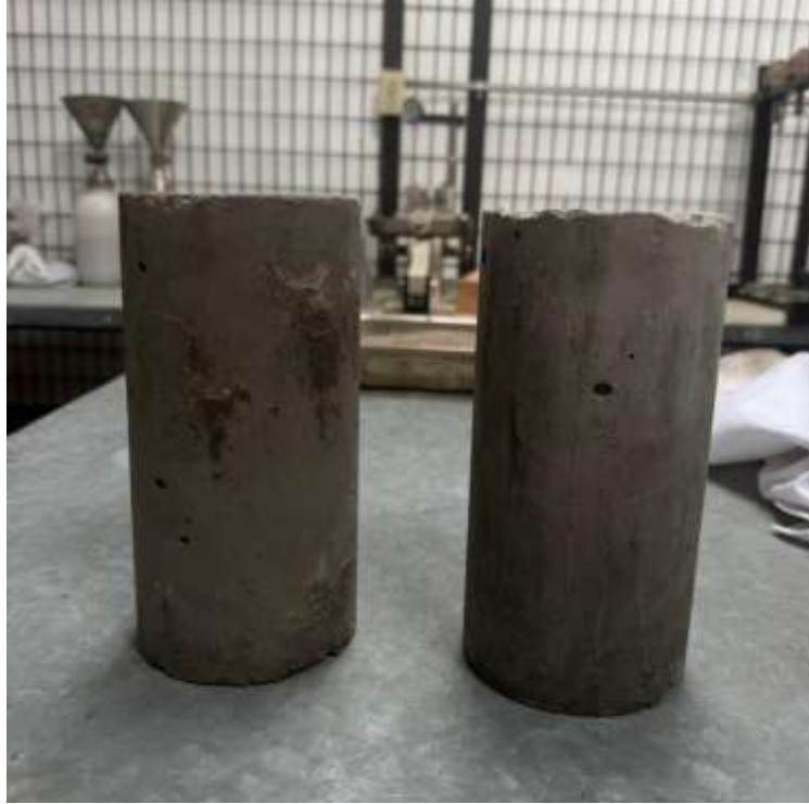
Figura 81. Cilindros Mezcla 7 finalizado el ensayo de durabilidad: absorción de agua hasta obtener masa constante.
