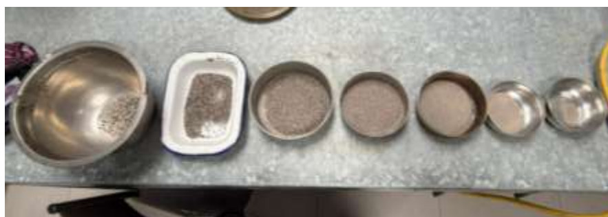
Figura 7. Fracciones retenidas por tamiz de la arena convencional durante el análisis granulométrico.
