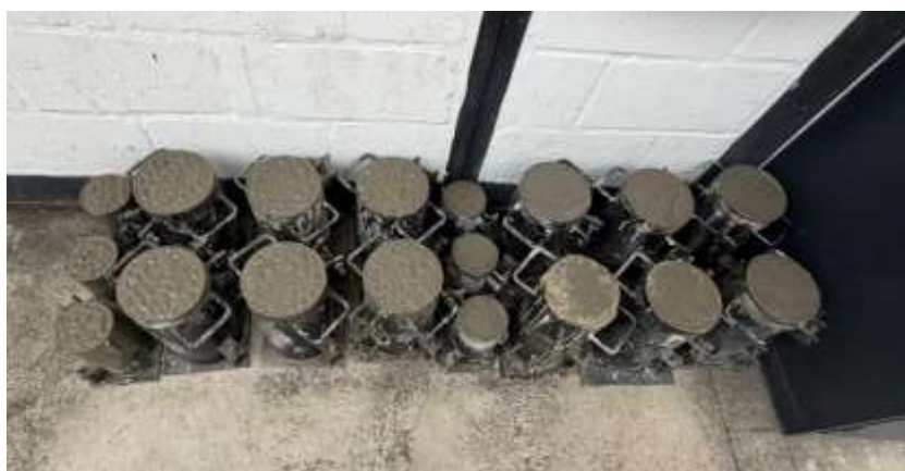
Figura 24. Cilindros de hormigón recién elaborados en moldes metálicos, previo al proceso de curado.
