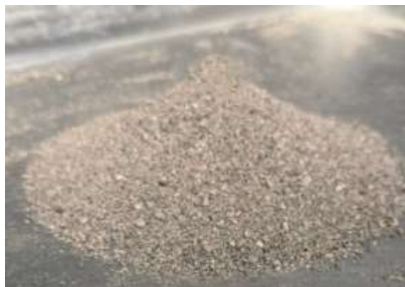
Figura 9. Muestra de polvo pómez S.S.S lista para ensayo de peso específico.
