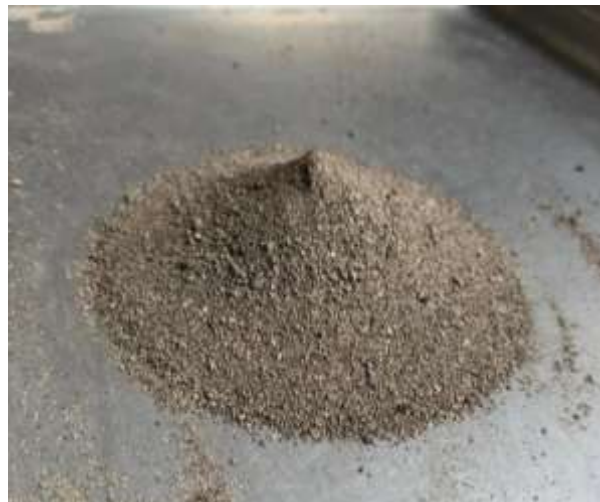
Figura 8. Muestra de arena convencional S.S.S lista para ensayo de peso específico
