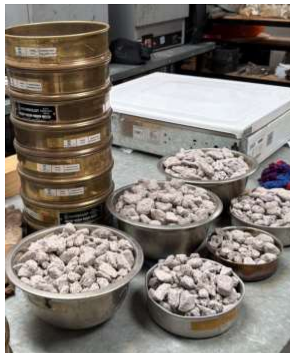
Figura 3. Recipientes para separar los agregados pasantes en cada tamiz.
