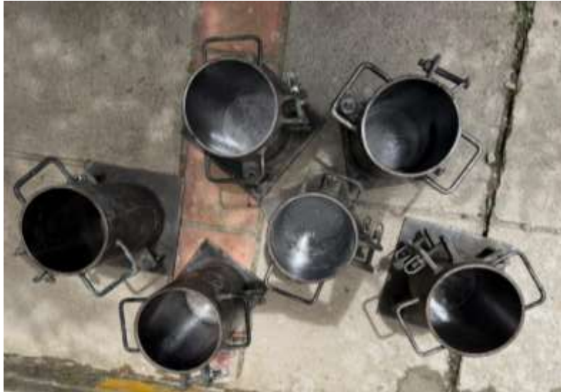
Figura 67. Preparación de los moldes cilindros para el vertido de la mezcla.
