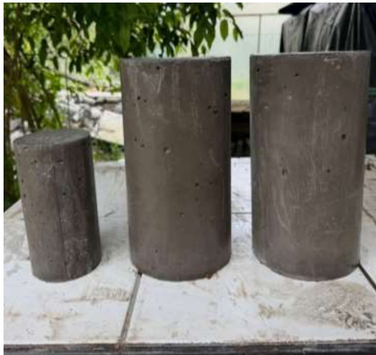
Figura 72. Cilindros de la Mezcla 2 previo al ensayo de compresión, tracción y durabilidad, tras ser extraído del tanque de curado por inmersión de agua.
