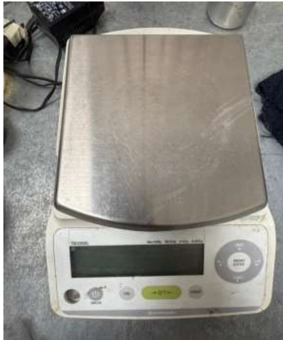
Figura 28. Balanza analítica con precisión de 0.01 g
