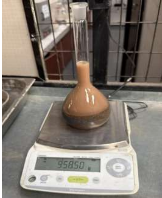
Figura 10. Pesaje del matraz con agua y muestra durante el ensayo de peso específico de arena convencional.
