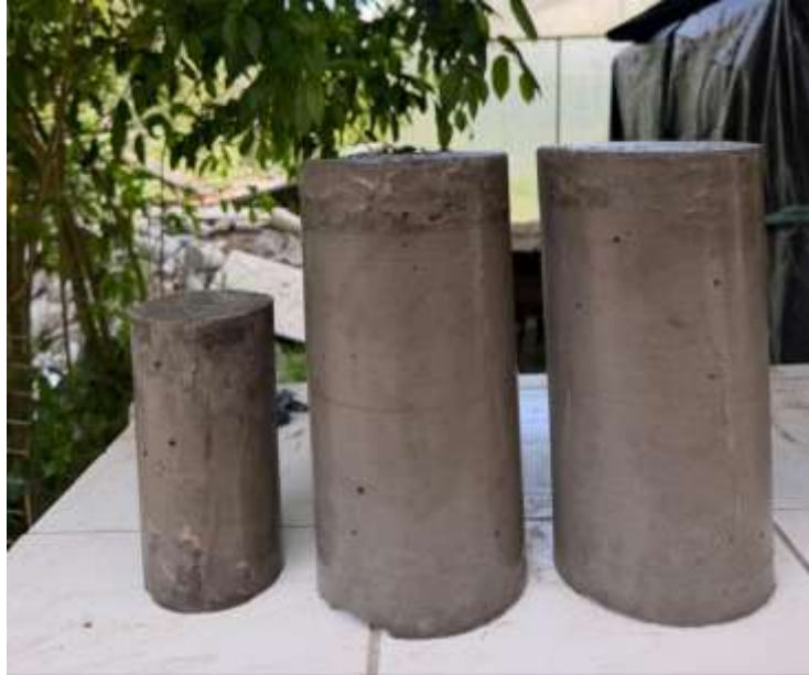
Figura 77. Cilindros de la Mezcla 7 previo al ensayo de compresión, tracción y durabilidad, tras ser extraído del tanque de curado por inmersión de agua.
