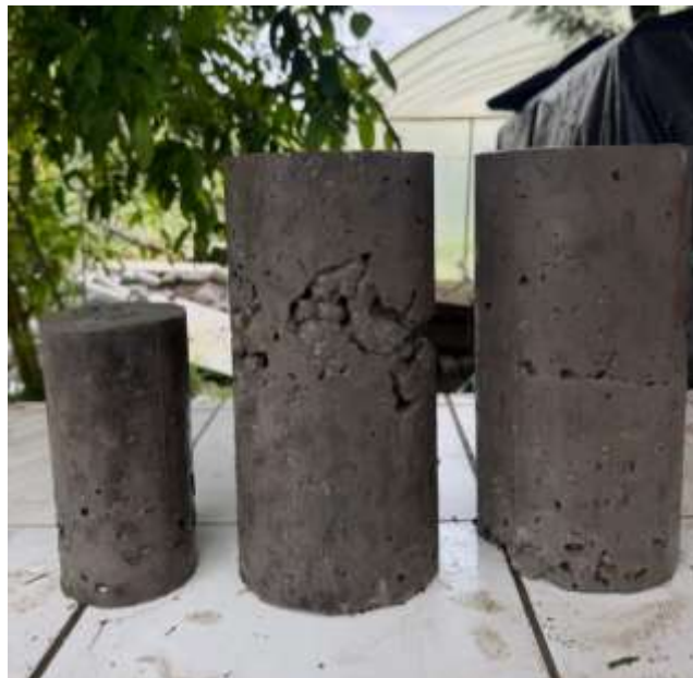
Figura 78. Cilindros de la Mezcla 7 previo al ensayo de compresión, tracción y durabilidad, tras ser extraído del tanque de curado por inmersión de agua.
