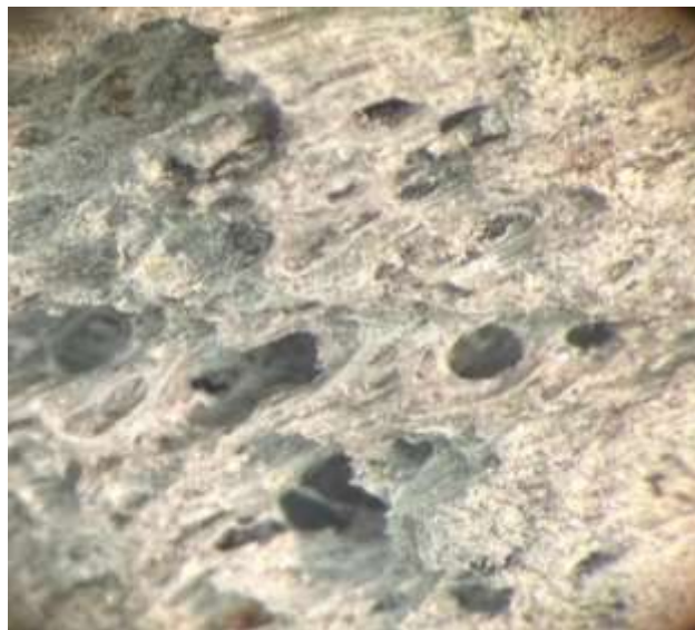
Figura 15. Observación microscópica de la piedra pómez.
