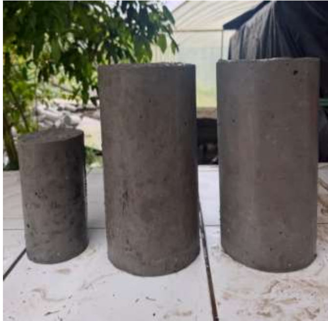
Figura 75. Cilindros de la Mezcla 5 previo al ensayo de compresión, tracción y durabilidad, tras ser extraído del tanque de curado por inmersión de agua.
