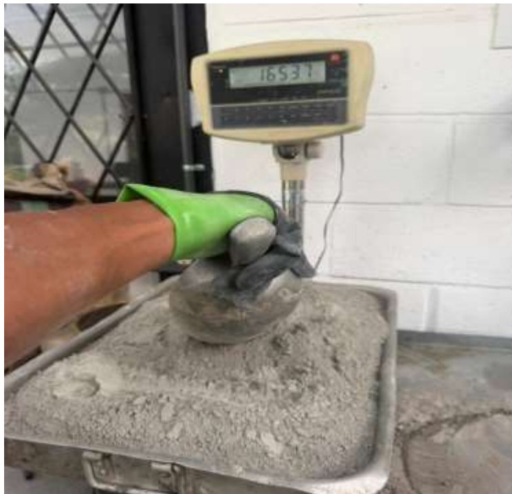
Figura 68. Pesaje de los agregados previo al mezclado.
