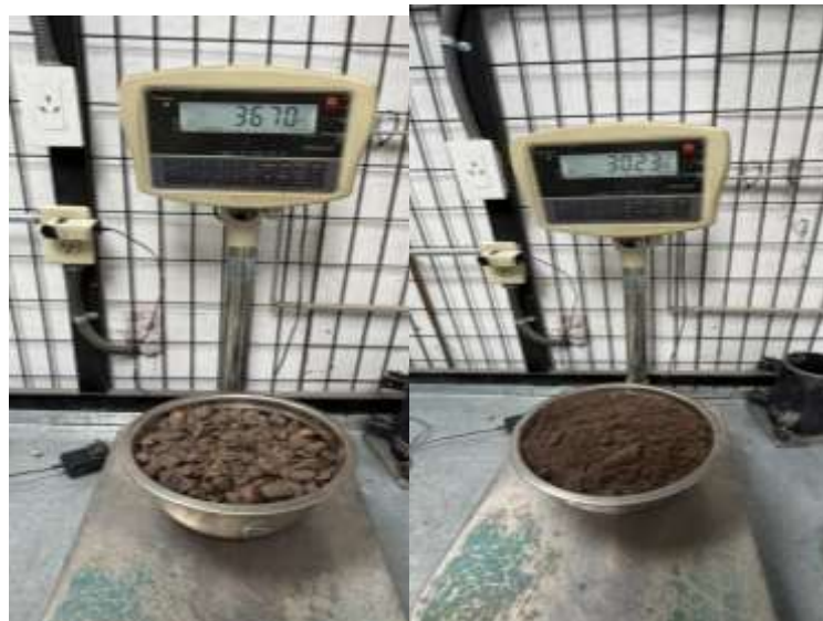
Figura 6. Pesaje de la muestra inicial previo al análisis granulométrico
