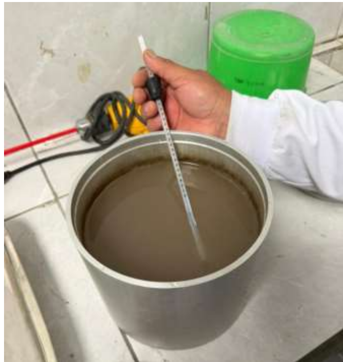
Figura 13. Medición de temperatura del agua durante el ensayo de peso específico del agregado grueso (ASTM C127).
