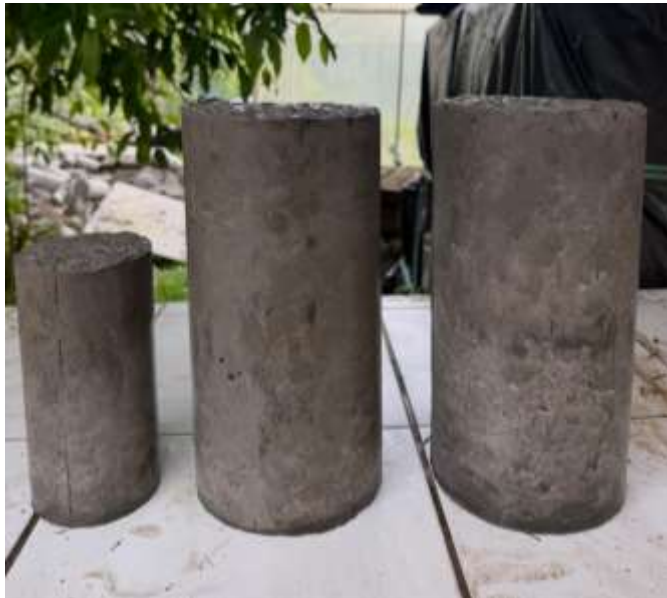
Figura 74. Cilindros de la Mezcla 4 previo al ensayo de compresión, tracción y durabilidad, tras ser extraído del tanque de curado por inmersión de agua.
