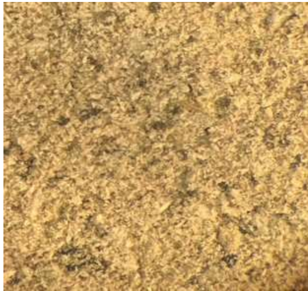
Figura 14. Observación microscópica del polvo pómez.
