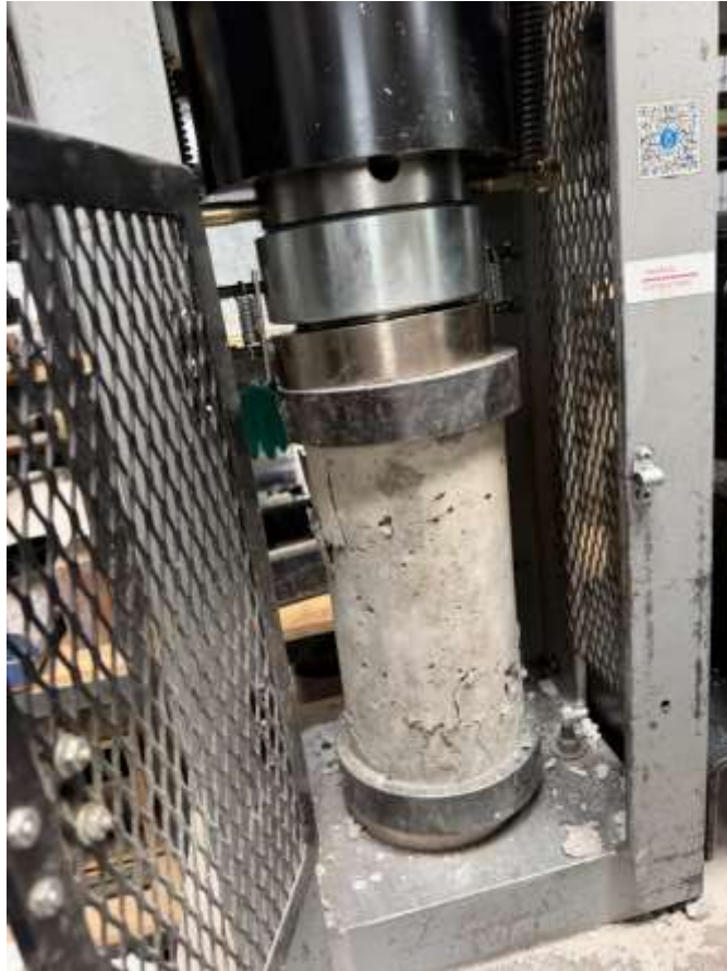
Figura 79. Rotura del cilindro mediante el Ensayo a Compresión
