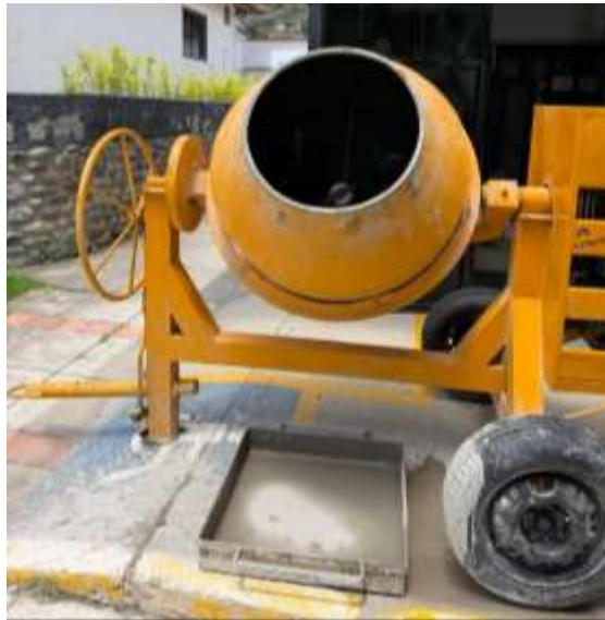
Figura 30. Concretera para la elaboración del mezclado
