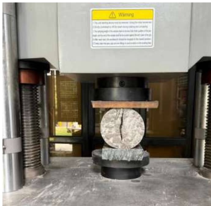
Figura 80. Rotura del cilindro mediante el Ensayo de Tracción indirecta
