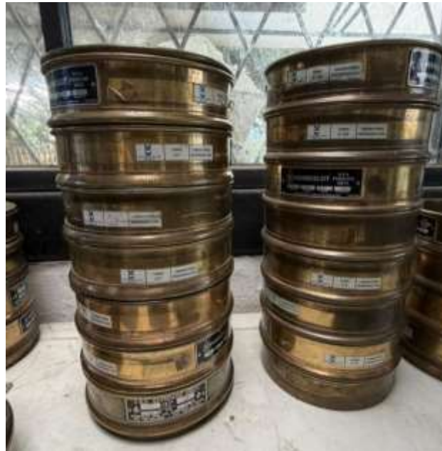
Figura 2. Juego de tamices utilizados para el análisis granulométrico de los agregados.
