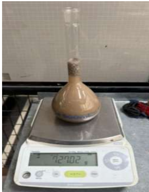
Figura 11. Pesaje del matraz con agua y muestra durante el ensayo de peso específico del polvo pómez.
