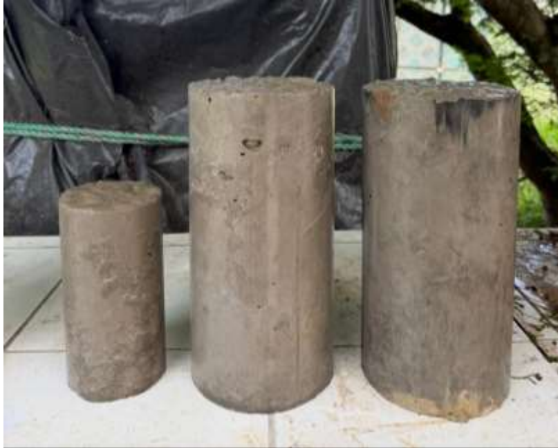
Figura 71. Cilindros de la Mezcla de control M1 previo al ensayo de compresión, tracción y durabilidad, tras ser extraído del tanque de curado por inmersión de agua.
