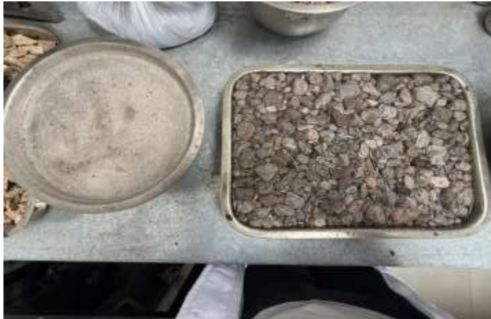
Figura 12. Saturación de la piedra pómez gruesa y polvo pómez durante 24 horas previo al ensayo de peso específico.
