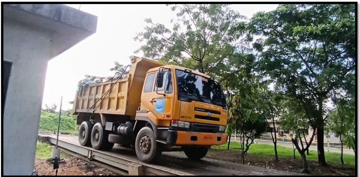
Figura 6. Volqueta cargada con residuos en báscula de relleno sanitario Samborondón.
