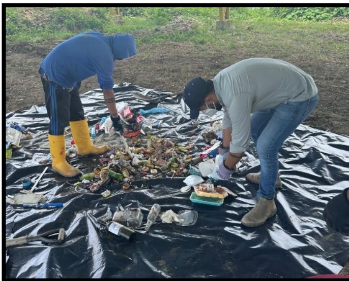
Figura 8. Método volumétrico directo en residuos RS Samborondón.
