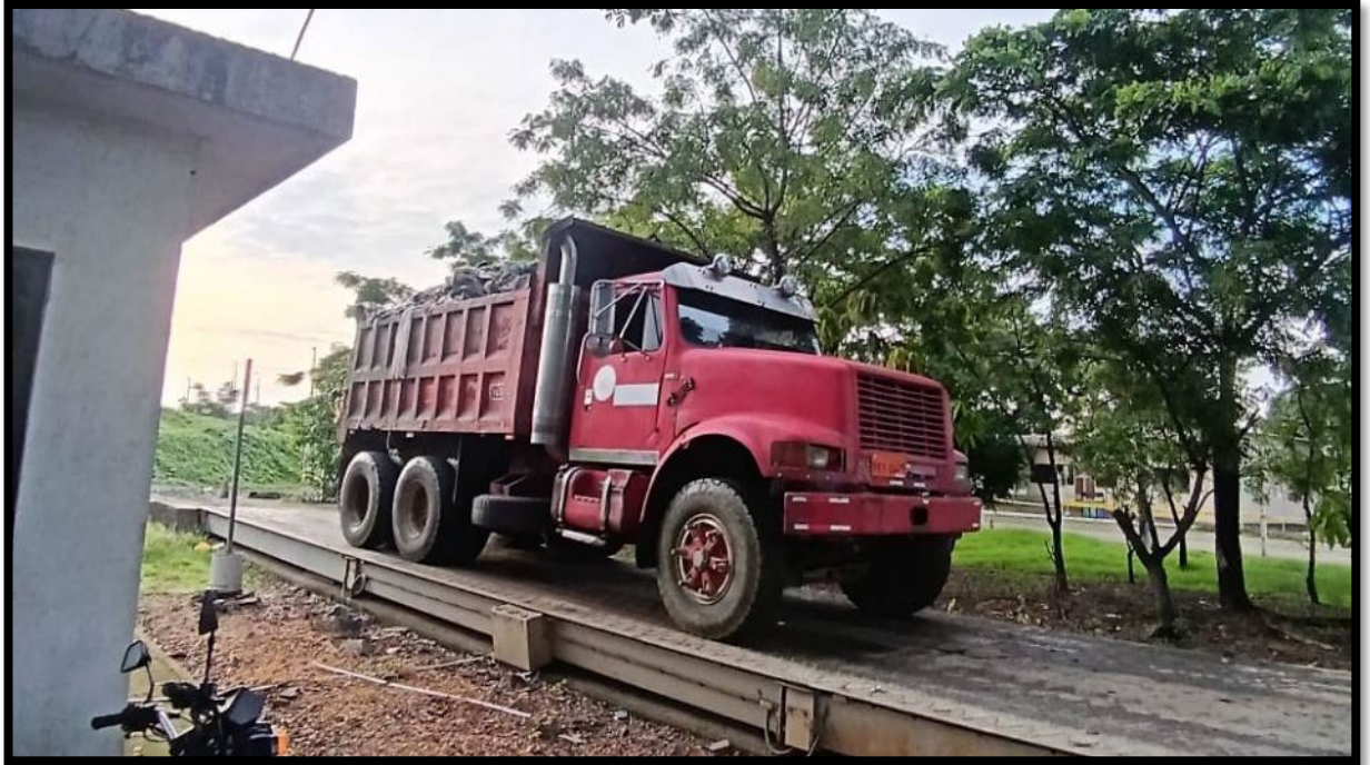
Figura 5. Volqueta cargada con residuos en báscula de relleno sanitario Samborondón.
