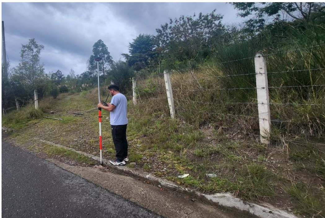
Imagen 10: Equipo técnico tomando puntos GPS de alta precisión, visualización del equipo en campo Fuente: Elaboración propia
