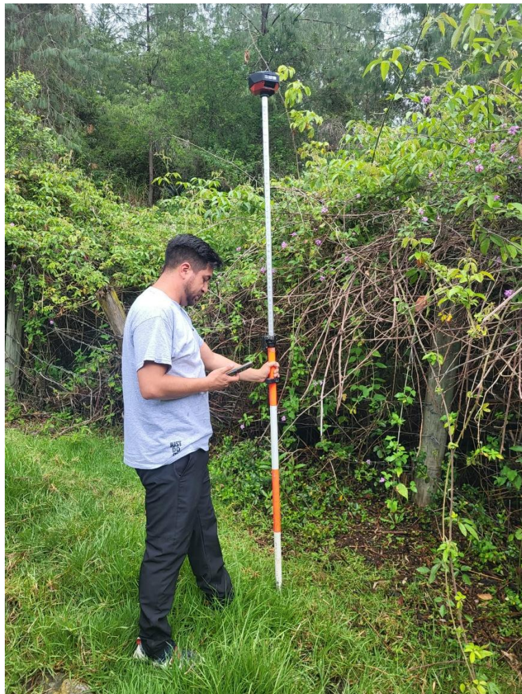
Imagen 12: Equipo técnico tomando puntos GPS de alta precisión, visualización del equipo en campo
