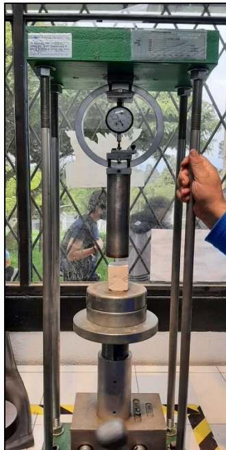
Foto 4: Resistencia uniaxial de laboratorio
