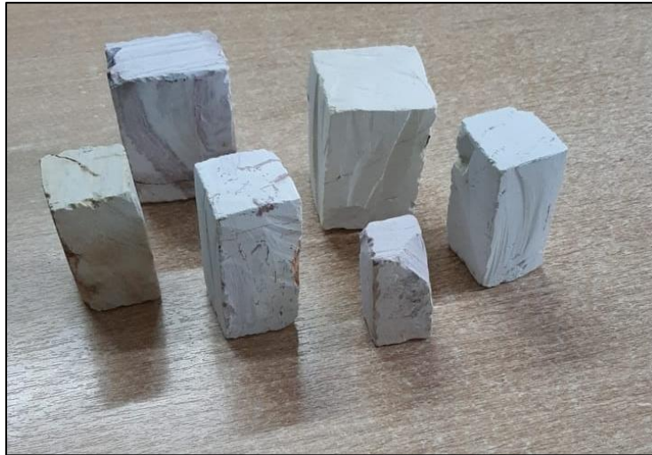
Foto 3: Muestras del material para ensayo de resistencia uniaxial de laboratorio
