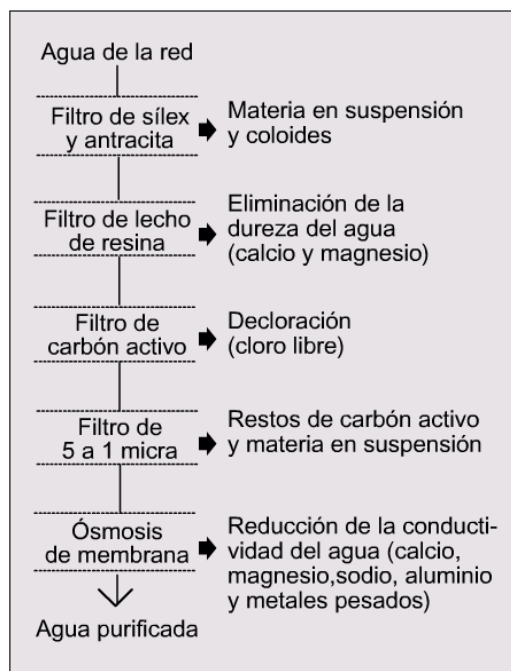
Cuadro 1: Proceso de purificación del agua 22
