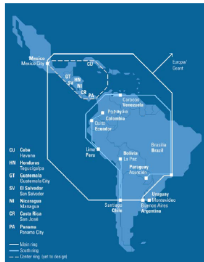
Figura 1.- Diagrama de la Topología de Red Clara. Fuente: www.cedia.org.ec
