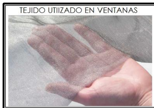
Figura 2.8. Malla utilizada en blindaje RF, material plata sobre poliamida.
