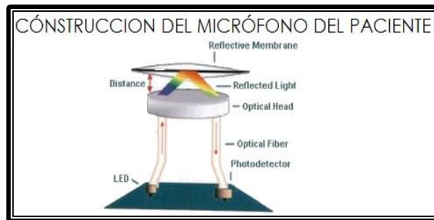
Figura 4.5. Micrófono que funciona a través de fibra óptica, no contiene metal.
