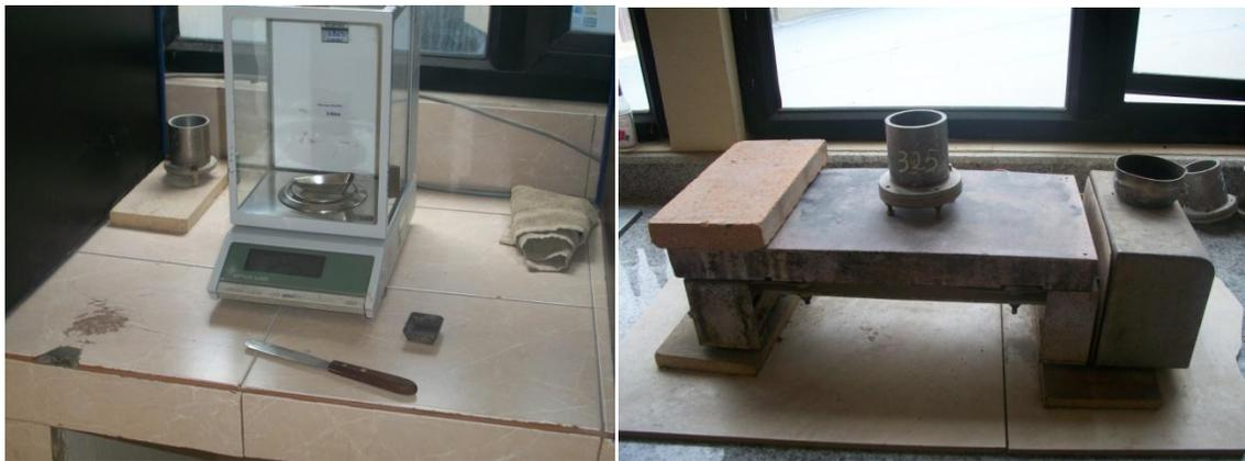
**Figura 5. Balanza analítica y tamiz de 45 micras**
