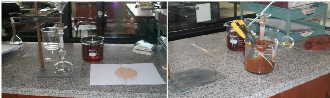
**Figura 8. Frasco de Le-chatelier, termómetro y diesel filtrado**
