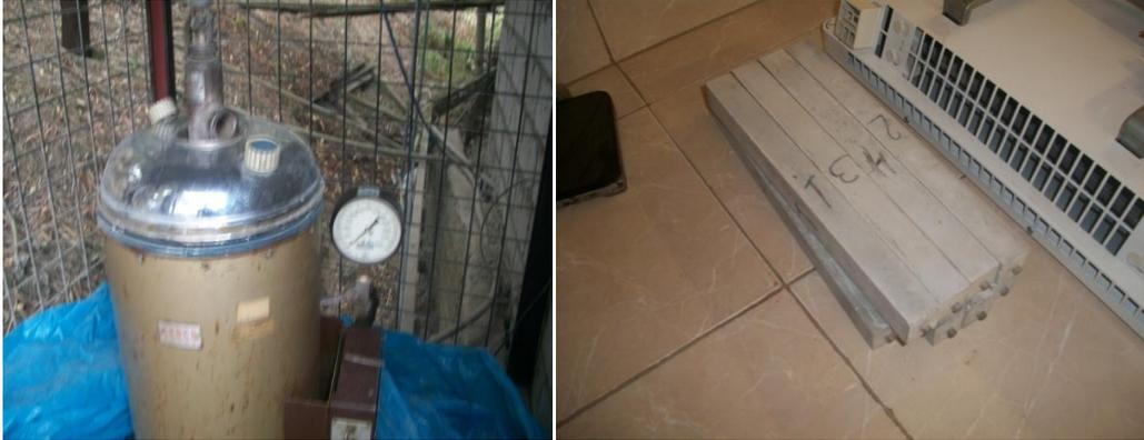
**Figura 11. Autoclave y barras de mortero**
