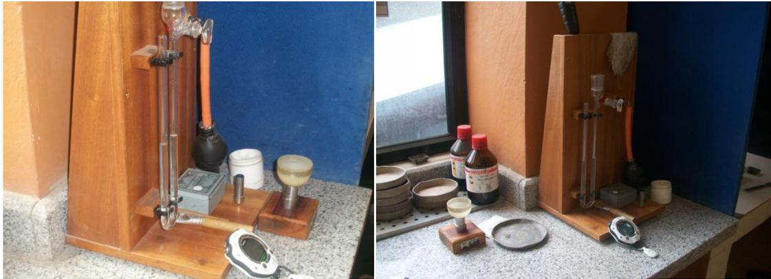
**Figura 9. Permeabilímetro de aire, liquido manométrico, cronómetro y filtros**
