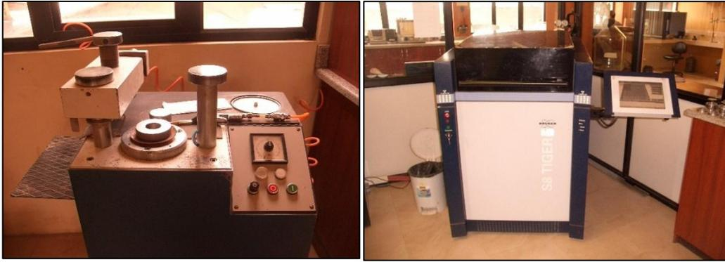
**Figura 6. Prensa electroneumática y equipo de fluorescencia de rayos X S8-TIGER. Marca Bruker. Fuente: Departamento de calidad (2012).**
