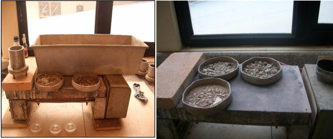
**Figura 3 Estufa térmica para desecación de muestras húmedas.**
