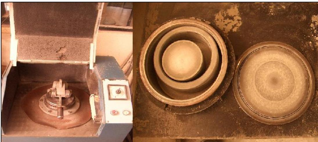
**Figura 4. Vibro molino para molienda de muestras secas.**
