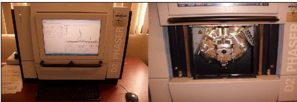
**Figura 7. Difractómetro de Rayos X D2 Phaser, marca Bruker. En funcionamiento (izq), Estructura interior para carga de muestras (der)**
