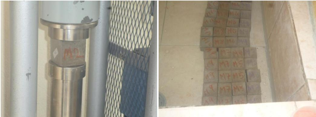
**Figura 11. Preparación de morteros, piscinas de maduración, cámara húmeda y máquina para pruebas de resistencia a la compresión**
