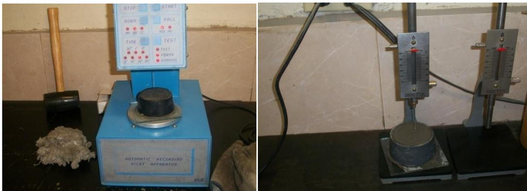
**Figura 10: Aparatos de vicat automático y manual**
