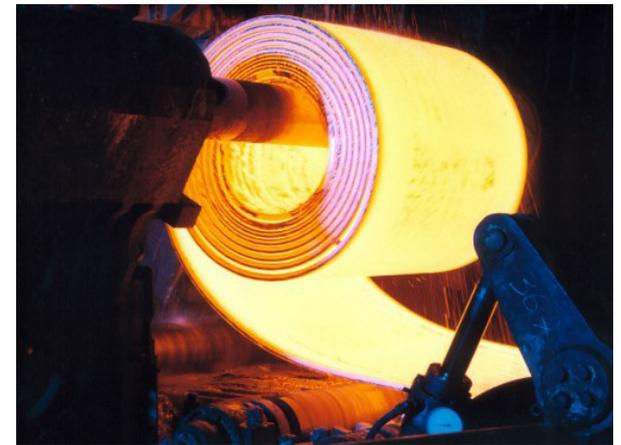
**Fig. 5:** Tren de laminación línea final
