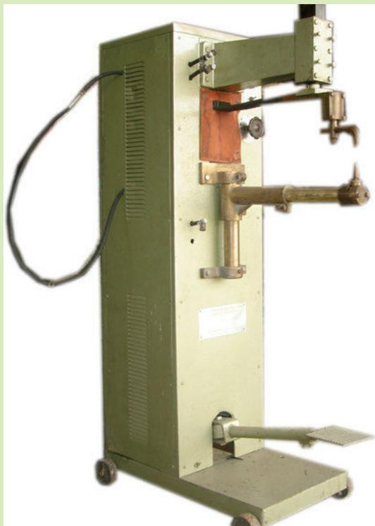
**Fig.8: Suelda de punto eléctrica**
