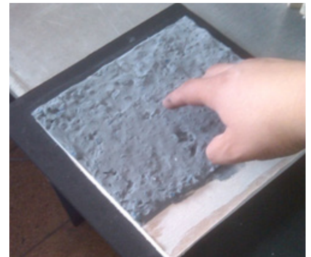
Instalación de los módulos aplicando mortero hidráulico en partes estratégicas del tablero
