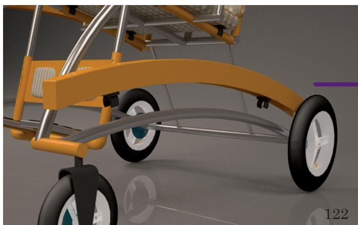
Carcasa en fibra de vidrio para cubrir la estructura. Esta es desmontable y permite un diseño personalizado.
