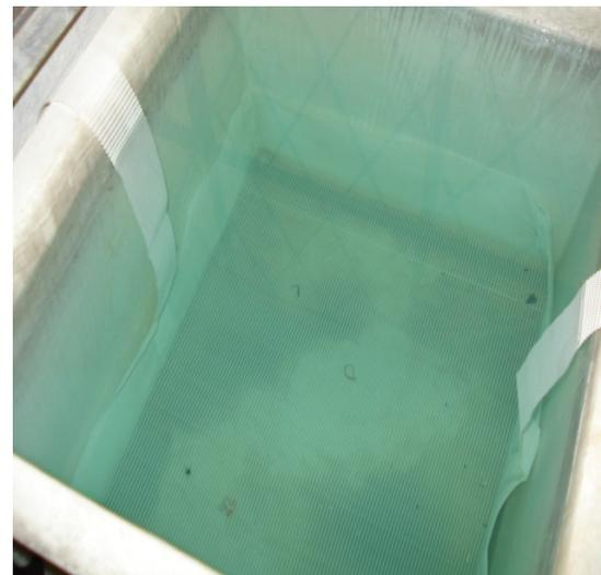
**Proceso Neutralizado:** Esta solución fría tiene el deber de cómo su nombre lo dice neutralizar el PH de las piezas, ya que para ingresar a la siguiente etapa deben entrar con un PH 0. Su concentración es al 20% de ácido sulfúrico en agua desmineralizada.
