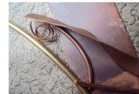
**LATÓN:** Aleación de cobre y zinc, de color semejante al del oro, maleable y muy resistente a la corrosión. Componen un grupo, caracterizados por ser buenos conductores del calor y de la electricidad, tener un brillo característico y ser sólidos a temperatura ambiente, salvo el mercurio.
