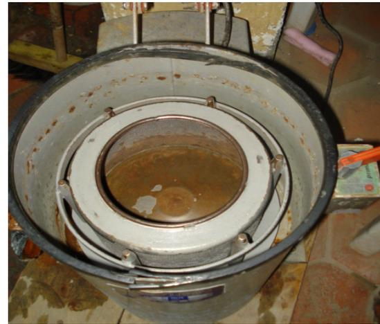
**Proceso Lavado:** sistema de agua tipo ducha para que el agua penetre y limpie todos los rincones de las piezas y se desprenda de las soluciones anteriores.
