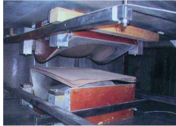
*Fig. 18. Se colocan las chapas de madera ya encoladas y pre tratadas en una prensa macho y hembra.*
