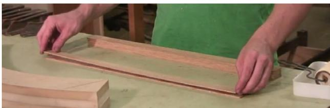
5. Se encolan las laminas de madera para ser colocarlas en un molde y a su vez este será puesto a presión por una prensa de enchapado o hidráulica.
