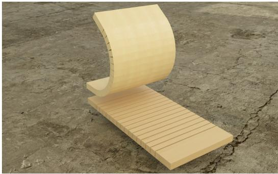
Se realizó experimentación con la entalladura generando diferentes profundidades de corte y variando la distancia.
