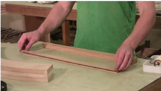
3. Luego se juntan varias laminas hasta lograr el espesor adecuado.
