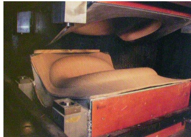
*Fig. 19. Al aplicar presión las chapas toman el la forma del molde y adicionalmente son mas resistentes debido a que se compactan las vetas y generan un vinculo mediante el encolado.*
