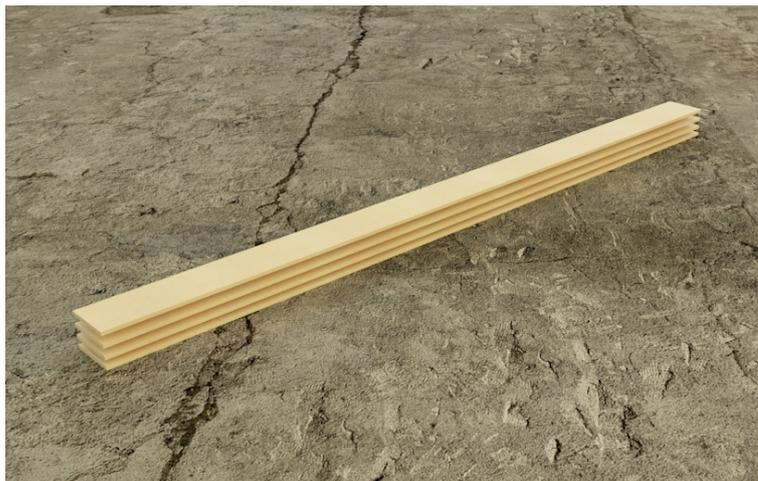
Este proceso consiste en cortar tiras de madera de 1.5, 2 hasta 3mm de espesor, al ser delgadas las tiras son más flexibles y pueden ser o no sometidas u humedecidas con agua esto dependerá del radio a generara.
