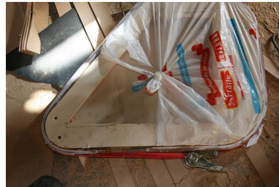
se unieron varias laminas de playwood y se encolaron para generar el espesor deseado. En esta ocasión se cubrió la mitad del molde con plástico, esto se realizo para analizar la dificultad del desmontaje.
