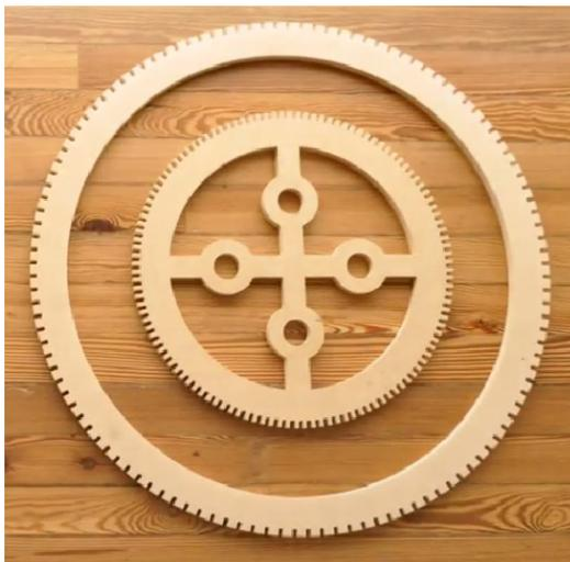
El primer paso es cortar dos circunferencias, de diferente radio ya que se va generar una figura cónica, estas figuras poseen ranuras en las cuales se encajara un tercer elemento
