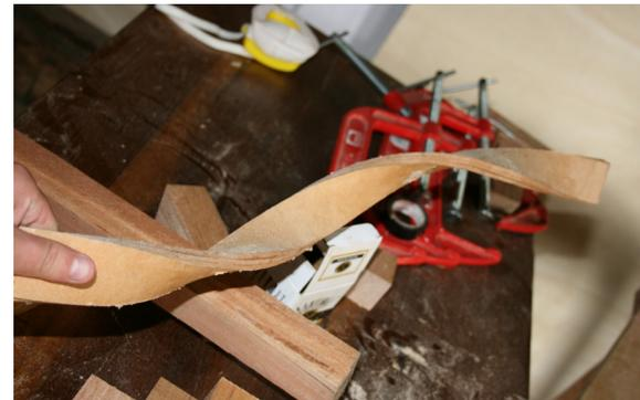
Ejemplo de la curvatura obtenida aplicando la técnica del twist.
