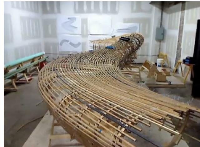
4. Mediante la utilización de prensas coloca los listones de cedro, al estar lista la superficie de la banca, retira los perfiles internos y los reemplaza por madera curva. Al terminar la colocación de la madera corta los excesos y les da los acabados correspondientes
