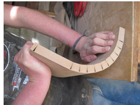
Con el mismo tablero de 18mm se realizaron cortes a una profundidad de 17mm con lo cual la flexibilidad aumentó y fue resistente ya que no presentó particiones por efecto de la presión.
