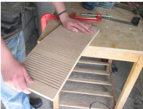
En este caso se utilizó un tablero de MDF con un espesor de 18mm y se realizaron cortes a una profundidad de 15mm con lo cual el tablero no fue maleable para generar una curvatura.
