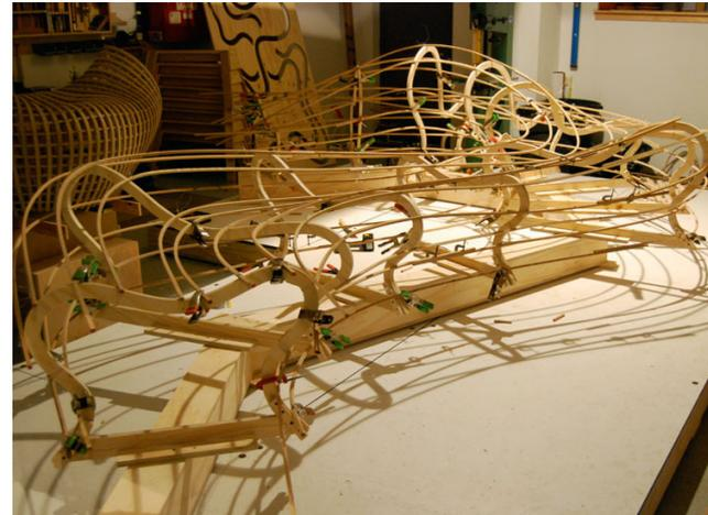
2. Luego coloca y sujeta los perfiles que funcionara como directriz, y que los realiza con tableros de madera.
