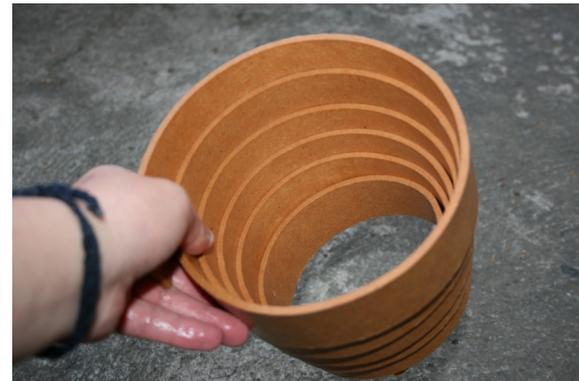
Se coloco cola blanca en la superficie del MDF y se elevo hasta generar una forma en espiral.
