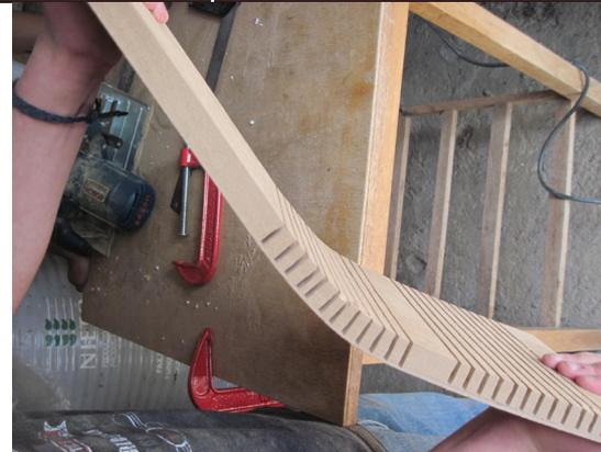
Como se puede observar en el mismo tablero se realizaron dos profundidades de cortes diferentes, en la sección que permite generar una curvatura se realizaron cortes con una profundidad de 16mm.
