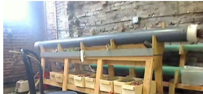
Un tubo de PVC retiene el vapor de una mejor forma, pero poseen radios que restringen el tamaño de la pieza a curvar, por ende se lo puede utilizar para tiras de madera.
