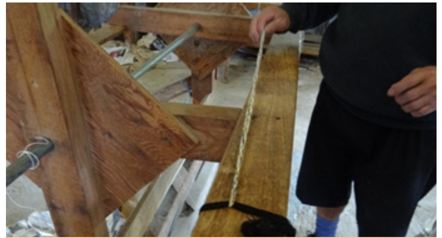
Se coloca en la urdidora un cordón doble
