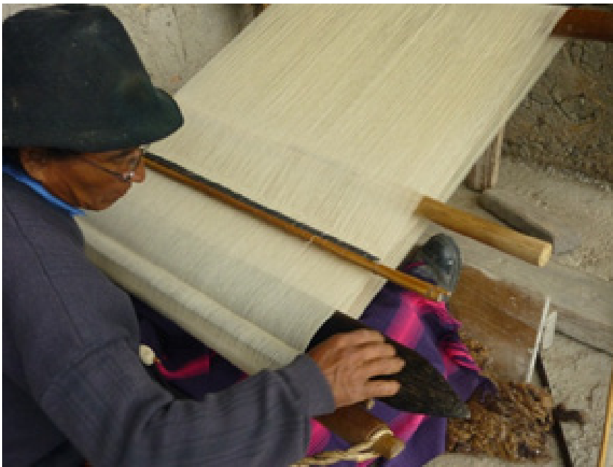
Se jala hacia abajo con fuerza y se golpea con el fin de apretar bien el tejido
