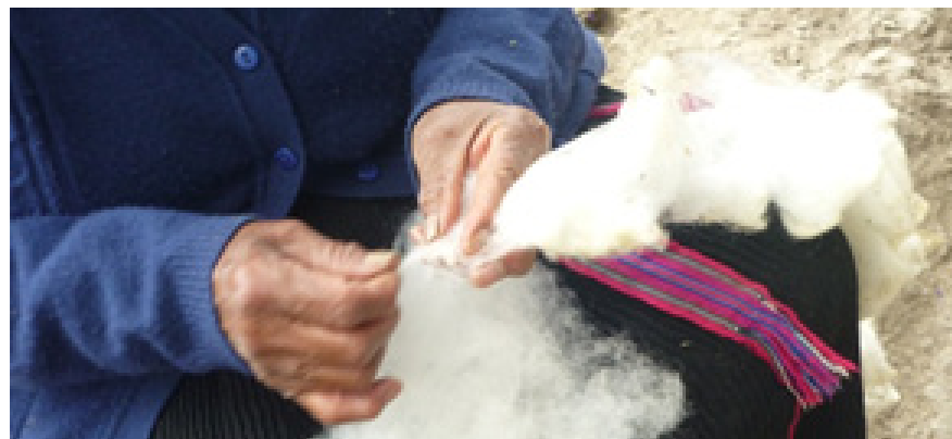
Abrir la lana para quitar impurezas y motas
