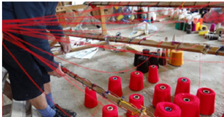
Pasados los hilos por los respectivos separadores
