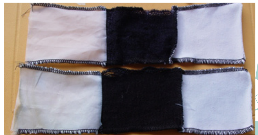
Muestra superior (tinte anilina) no sangró, muestra inferior (tinte índigo) presenta una ligera coloración azul en los dos testigos
