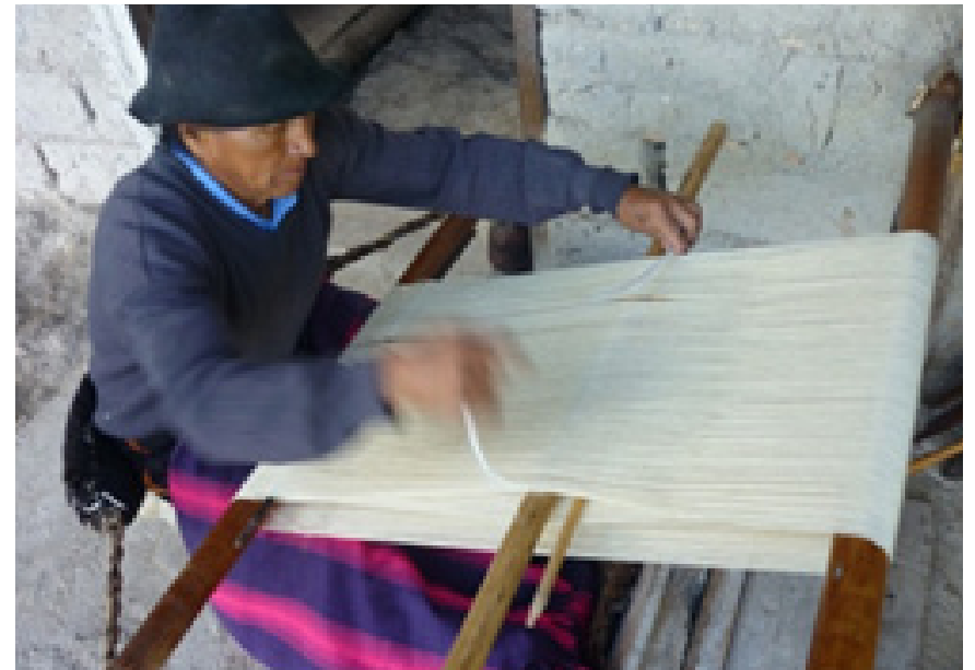
Extender los hilos de la urdimbre para ordenarlos un poco
