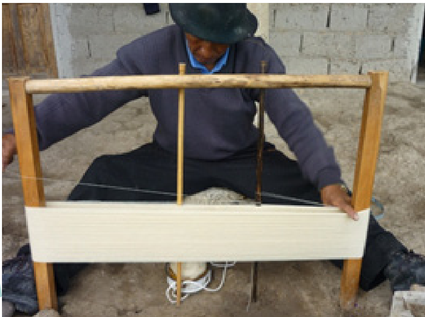
En la parte central se encuentran dos tactes pequeños, en los cuales se va pasando el hilo en forma envolvente y entrecruzada.
