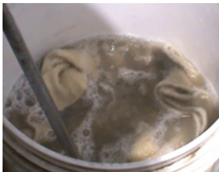
Se aplasta y mueve la lana con la ayuda de un hierro/palo
