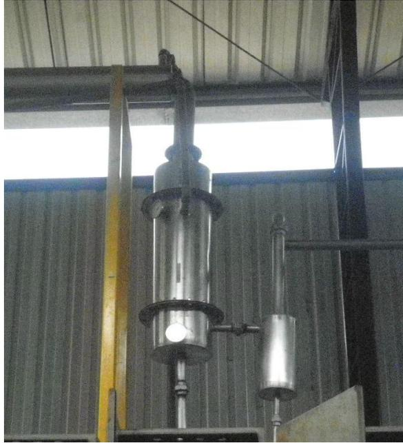
Figura 2.6. Intercambiador de condensación.
