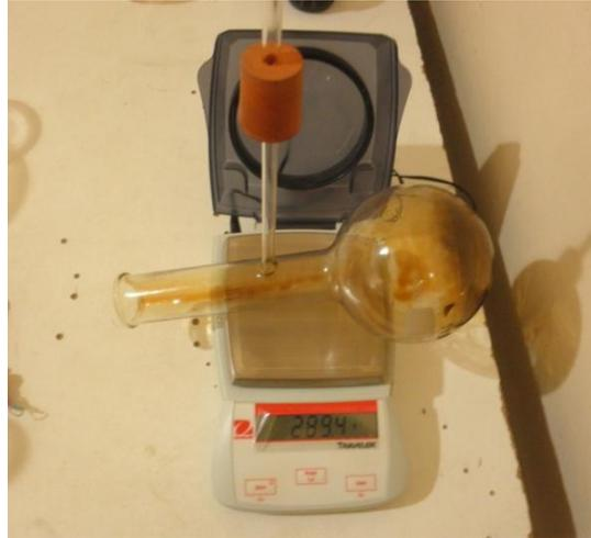
Figura 3.24. Peso del balón con residuo de aceite.
