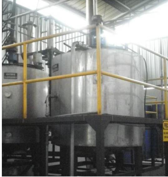
Figura 2.21. Reactores de clarificación.
