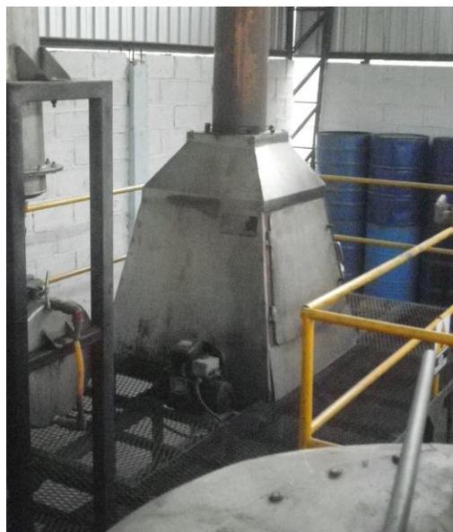
Figura 2.16. Horno de fraccionamiento y quemador de diesel.
