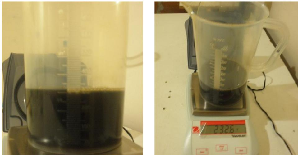
Figura 3.17. Peso de la mezcla aceite solvente para destilar.
