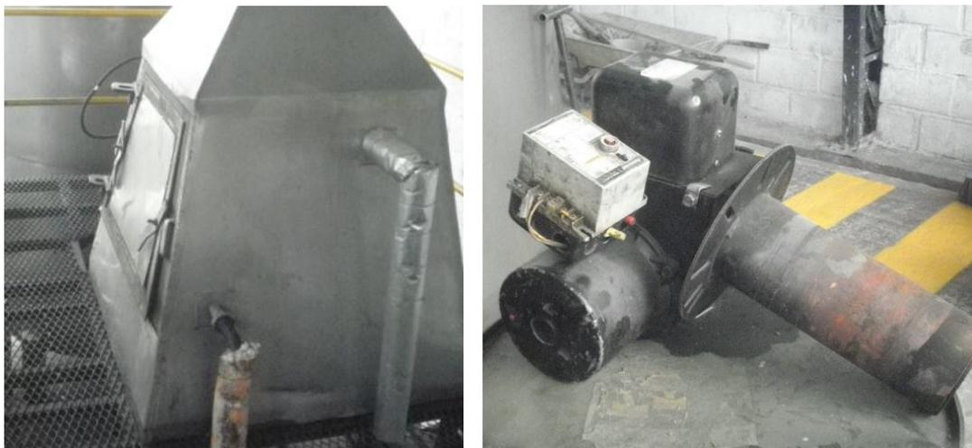
Figura 2.3. Horno de fraccionamiento y quemador de diesel.
