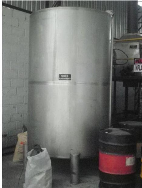
Figura 2.2. Tanque de almacenamiento de aceite usado.
