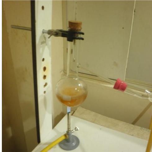
Figura 3.20. Evaporación solvente.
