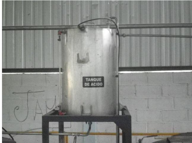
Figura 2.11. Tanque de almacenamiento químico.
