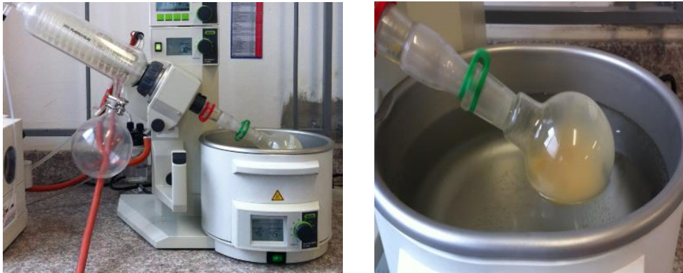
Foto 4: Destilación de la muestra de chicha de jora
