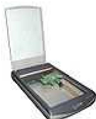
Un escáner es un periférico que se utiliza para convertir, mediante el uso de la luz, imágenes o cualquier otro impreso a formato digital. Actualmente vienen unificadas con las impresoras formando multifunciones.
