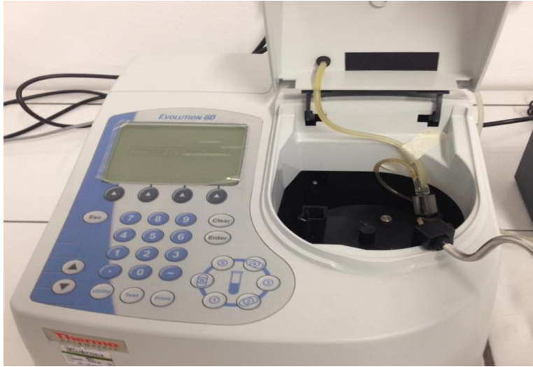
Figura 11. Espectrofotómetro utilizado en los ensayos de inhibición enzimática de las enzimas \alpha y \beta - glucosidasa.
