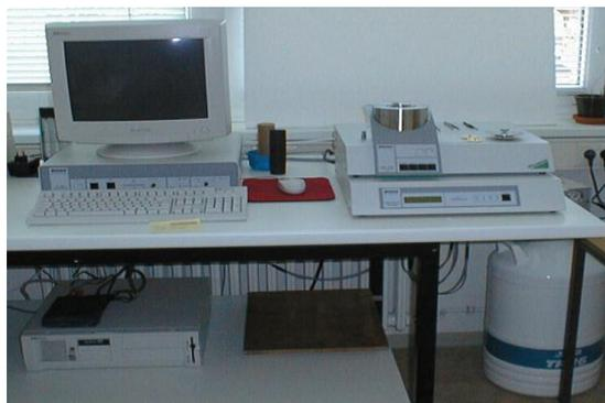
**Figura 10.** Calorímetro diferencial de barrido con dispositivo de baja temperatura
