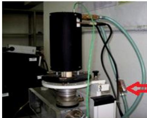
**Figura 46.** Revisión del flujo de agua de refrigeración.
