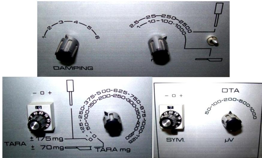
Figura 59. Calibradores manuales de la termobalanza.
