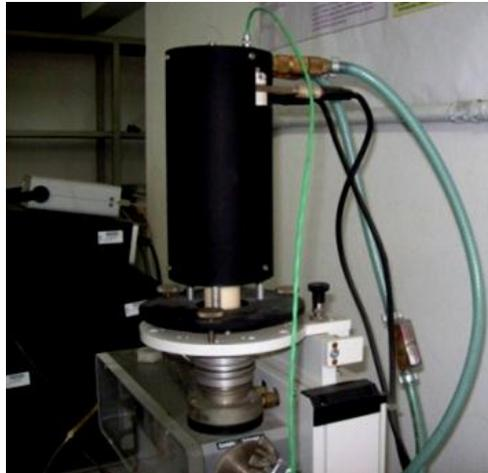
**Figura 15.** Dispositivo de termoanálisis-Termogravimetría simultaneo.
