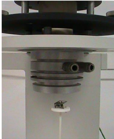
**Figura 42.** Colocación de las muestras en la termobalanza.
