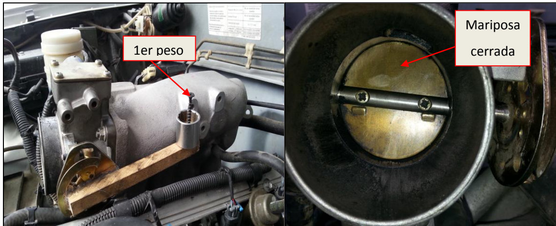
Figura. 2.9. Segunda etapa de prueba primer peso (0,065 kg.)
