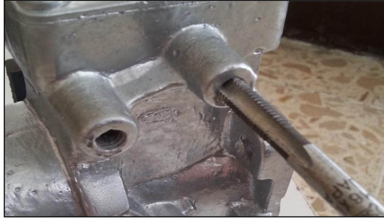
Figura. 3.7. Roscado de agujeros para sujeción del servo motor.
