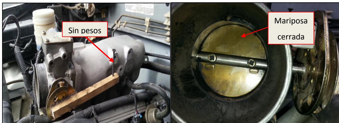
Figura. 2.8. Primera etapa de prueba (sin pesos)
