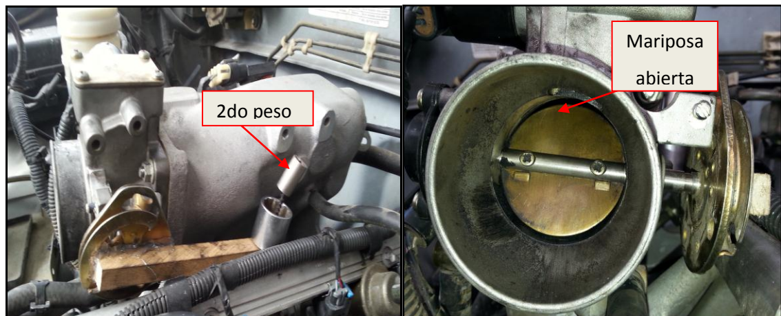
Figura. 2.10. Tercera etapa de prueba segundo peso (0,01kg.)
