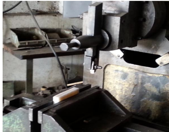
Cepillado y maquinado del grilón.
