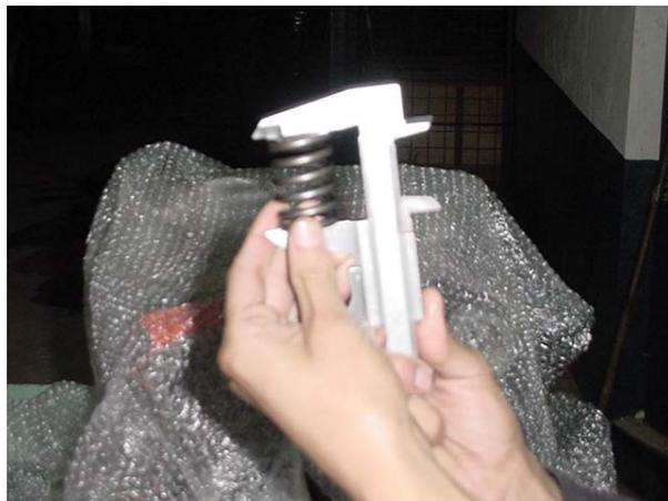
Foto 3.17.- Altura de los muelles de válvulas
