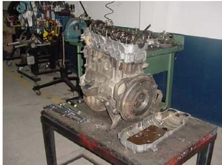
Foto 2.4 Desmontaje de la tapa válvulas
