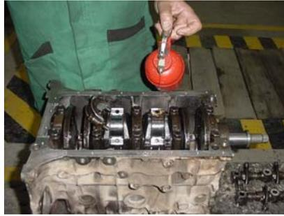
Foto 3.3.3.1.- Proceso de montaje del cigüeñal.
