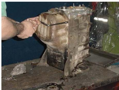
Foto 2.13.- Retirada pernos sujeción carter
