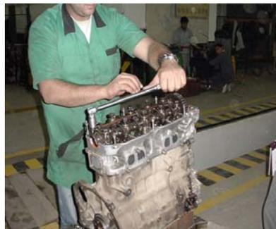
Foto 2.7 Desmontaje de pernos del cabezote.
