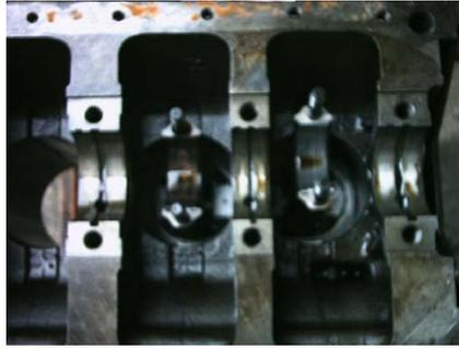
Foto 3.4:- Deformación de las Bancadas
