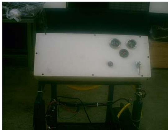
Foto 4.1.1.2 Armado del tablero de instrumentos del banco didáctico
