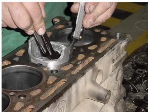
Foto 3.1.- Medición desgaste de cilindro.
