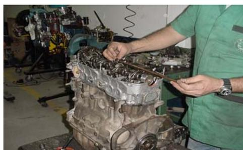
Foto 2.10 Desmontaje del de riel de lubricación.
