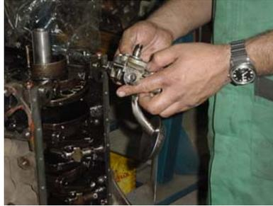
Foto 2.17 Desmontaje bomba aceite
