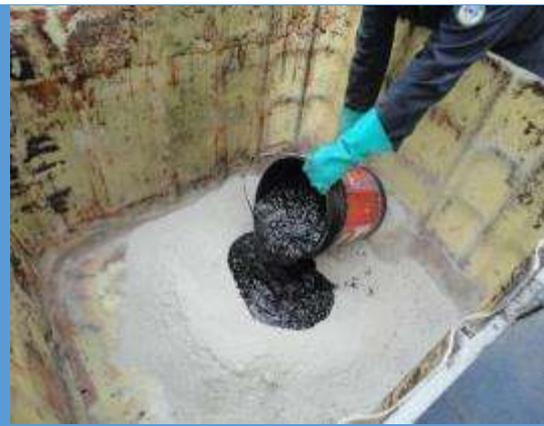
**Fotografía 10:** Vista de la mezcla de lodos aceitosos más ECOSOIL o SPHAG SORB, para la desintoxicación.
