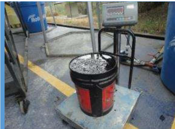
**Fotografía 9:** Vista del proceso de pesaje de los lodos aceitosos.
