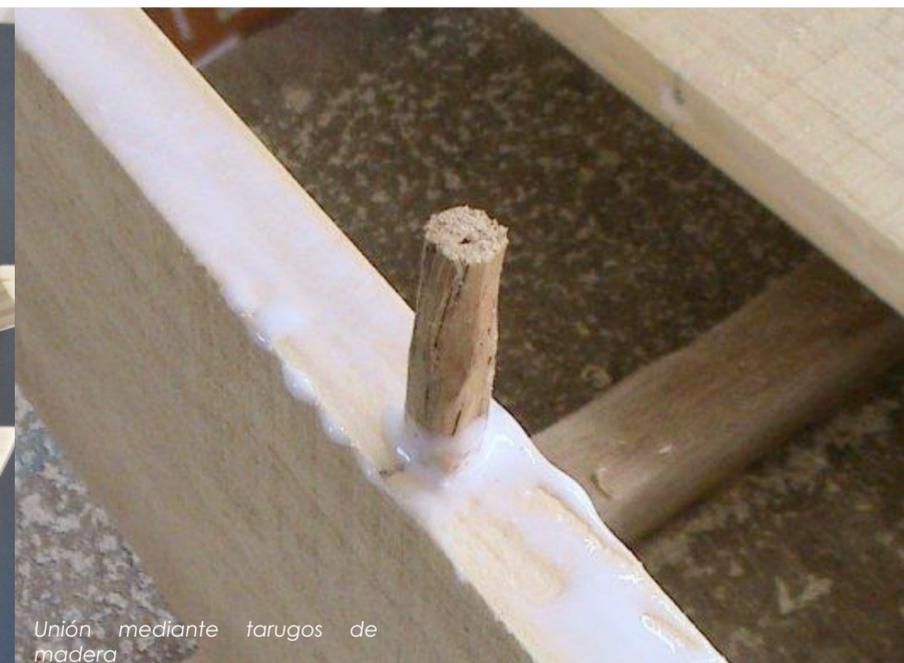
Unión mediante tarugos de madera
