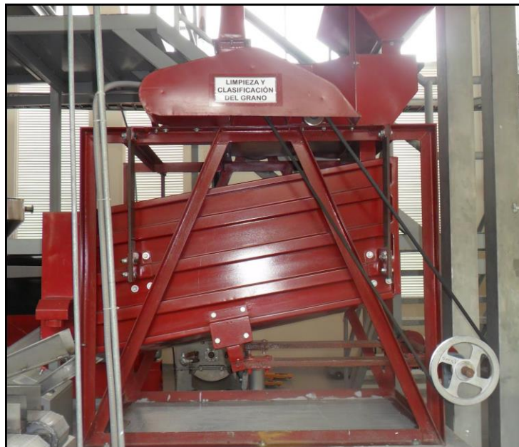
Imagen N° 11. Máquina de clasificado del cacao.
