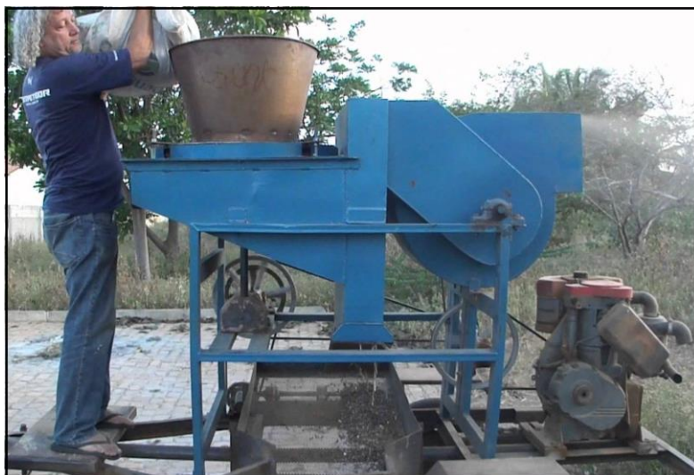
Imagen N° 13 Máquina de descascarillado.
